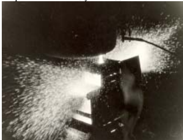
Рисунок 5 – Обдув чугуна встречными струями
