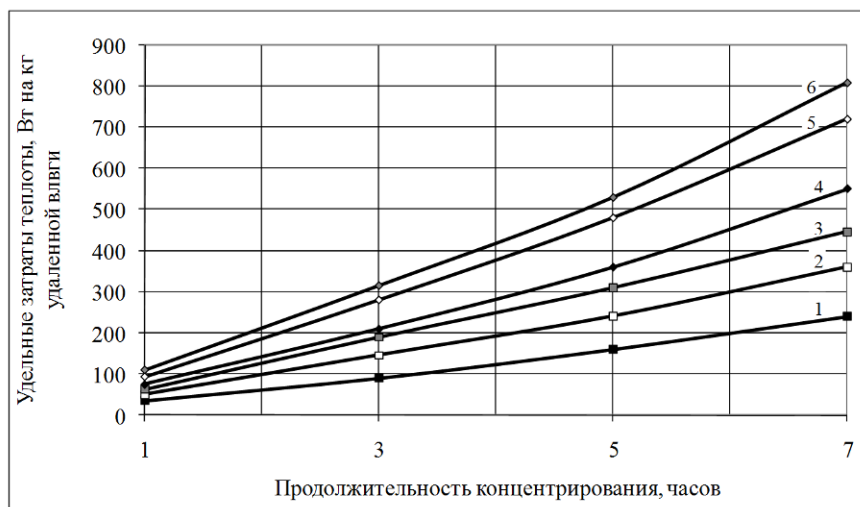
рис. 1. Зависимость удельных затрат теплоты на концентрирование молочной сыворотки от продолжительности концентрирования: 1-50 °C; 2-60 °C; 3-70 °C; 4-80 °C; 5-90 °C; 6-100 °C
