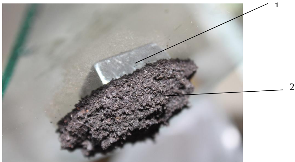
Рис. 1. Магнитоуправляемый гидрофобизированный нефтесорбент «Магнесорб»: 1 – постоянный магнит; 2 – сорбент (порошок).
