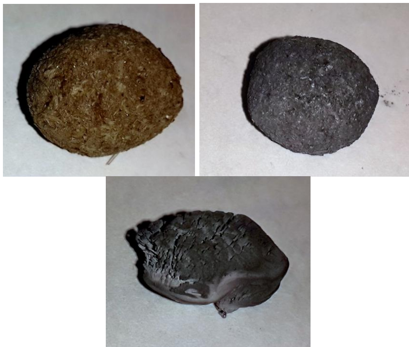
Рис. 1: Образцы до и после осуществления процесса термической переработки: а – исходные гранулы, б – гранулы после термического упрочнения, в – образец пироуглерода, образующийся в реакторе в ходе процесса
