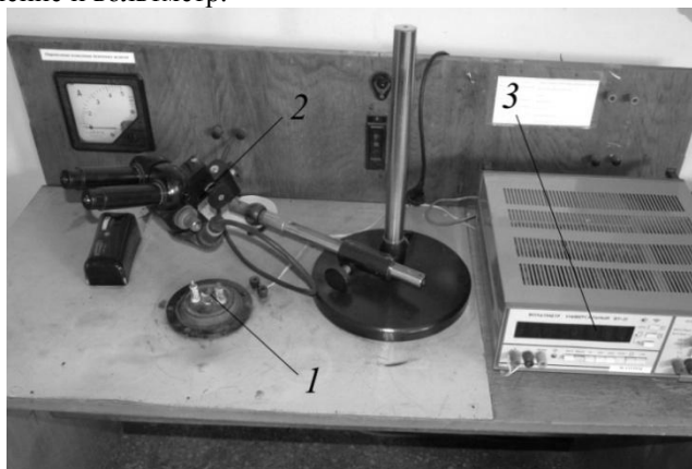
1 – микропечь; 2 – микроскоп; 3 – милливольтметр
