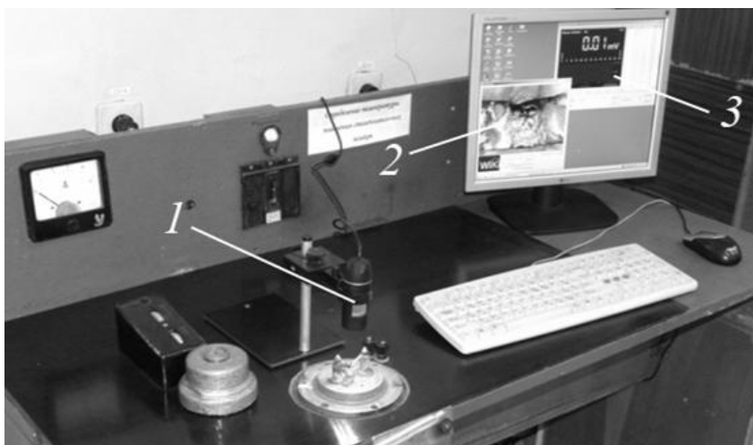
1 – цифровой микроскоп; 2 – изображение платиновой пластины; 3 – показания термопары
