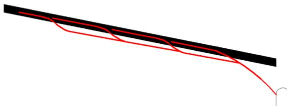
Рис. 7. Предварительная дегазация пласта
