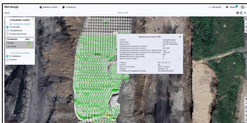
Рис. 6. Информация, получаемая с буровой установки
