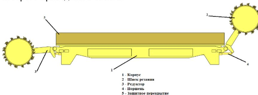
Рис. 3. Общий вид 3D-модели очистного комбайна Eickhoff SL 750 и составных элементов
