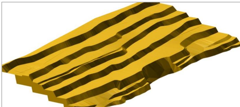
Рис. 12. Каркас вскрышных уступов, планируемых к экскавации в 2023 году
