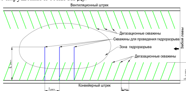
Рис. 5. Схема обустройства выемочного участка для проведения гидроразрыва угольного пласта
