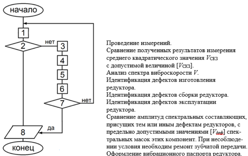
Рис. 4. Блок-схема и алгоритм идентификации дефектов редукторов по параметрам виброакустического сигнала
