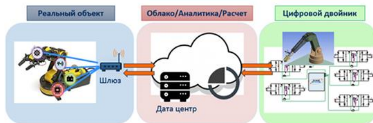
Рис. 2. Общая структура технологии «цифровой двойник»
