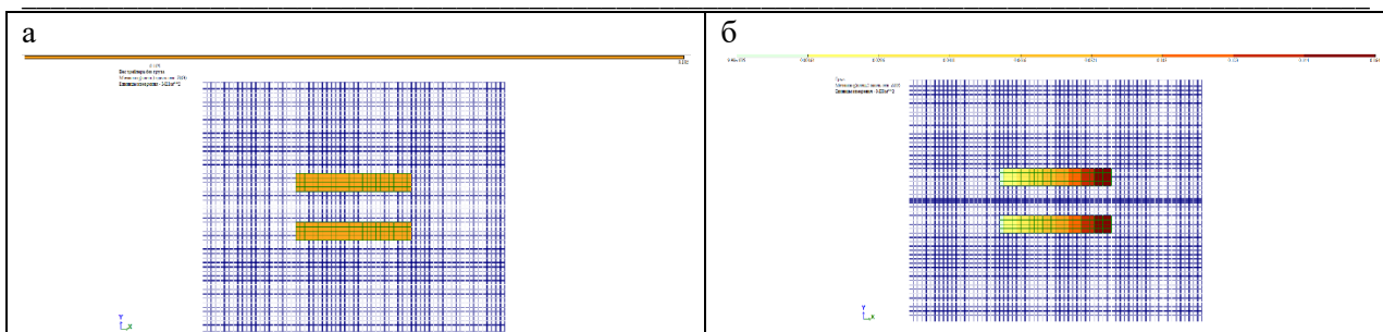
Рис. 2. Мозаика нагрузок от собственного веса монтажной машины (а), мозаика давления на бетон от веса транспортируемого груза (б)
