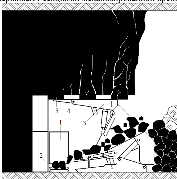
1 – очистной комбайн; 2 – забойный скребковый конвейер; 3 – секция механизированной крепи поддерживающе-оградительного типа; 4 – каналы; 5 – целики угля Рис. 5. Поперечный разрез очистного забоя
