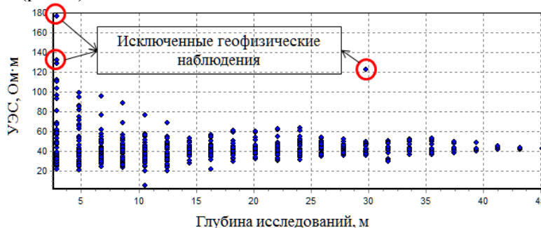
Рис. 2. График анализа процесса фильтрации геофизических наблюдений
