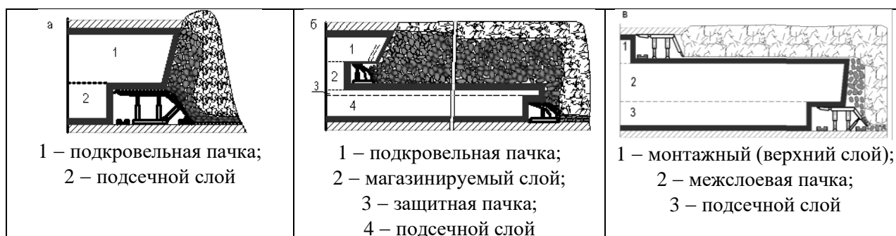
Рис. 1. Схемы выпуска угля из подкровельных и межслоевых пачек угля при отработке мощных пологих пластов: а – без предварительной отработки верхнего слоя; б – с подработкой верхнего слоя и магазинированием угля; в – схема выпуска угля из межслоевой пачки
