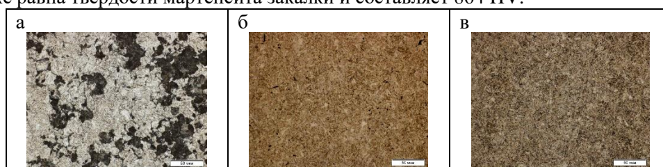
Рис. 3. Структура стали R350LHT после непрерывного охлаждения со скоростями 10 (а), 30\text{ }^{\circ}\text{C}/\text{c} (б), 100\text{ }^{\circ}\text{C}/\text{c}
