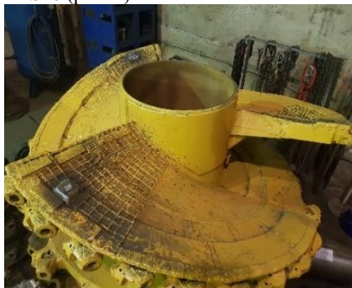
Рис. 2. Защитные пластины на шнеке комбайна JOY 4LS20
