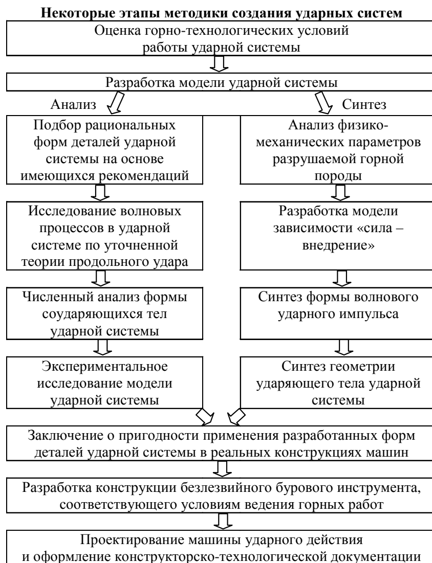
Рисунок 1 – Схематичное представление методики создания ударных систем технологического назначения
