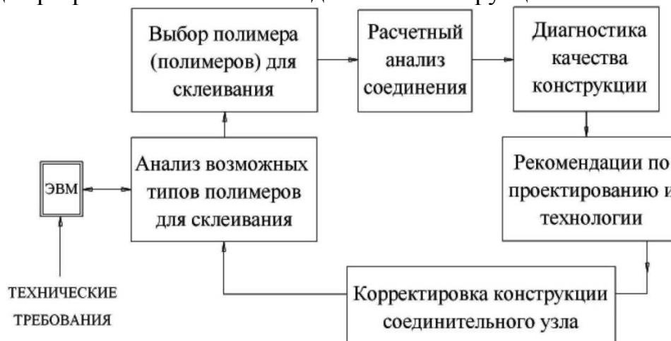
Рисунок 4 – Экспертная система для разработки клеевого соединения.
