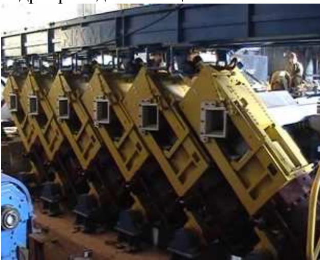
Рисунок 1 – Летучие гидравлические ножницы с шевронными ножами
