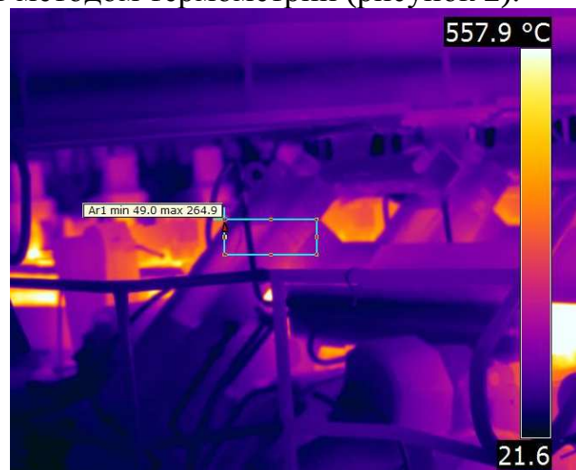
Рисунок 2 – Типовая термограмма на участке ножниц МНЛЗ
