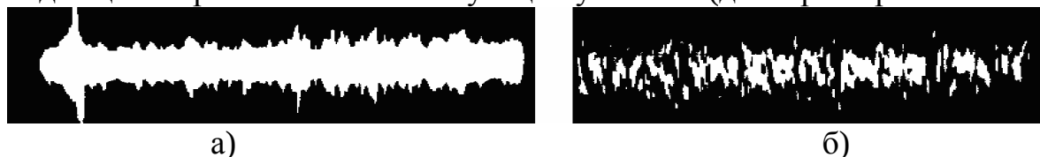
Рисунок 3 – Осциллограмма, начала развития (а) и самого процесса (б) заедания
