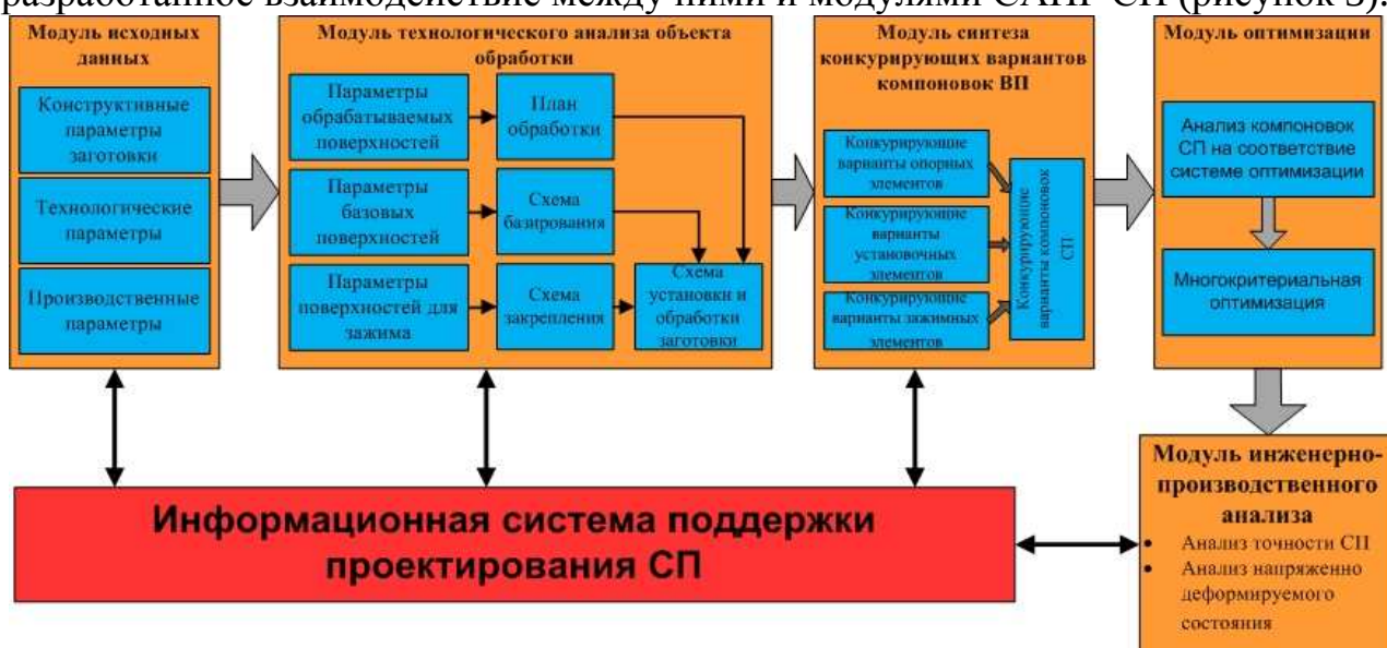
Рисунок 2 – Разработанная структура САПР СП
