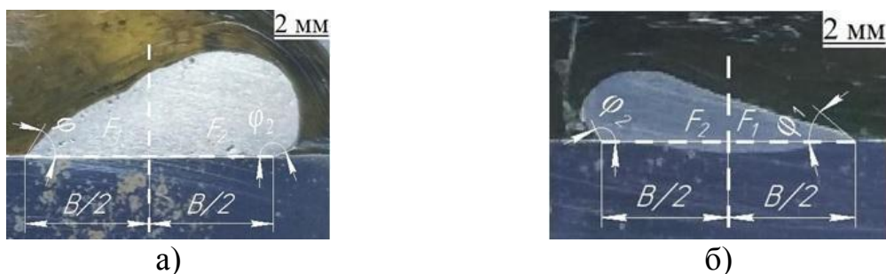
Рисунок 2 – Внешний вид поперечных сечений горизонтальных валков, наплавленных на наклонную плоскость с применением разработанных композиционных наплавочных прутков состава, масс. %: а) Б83 + 3 (Al-Bi); б) Б83 + 3 Ti 2 NbAl.
