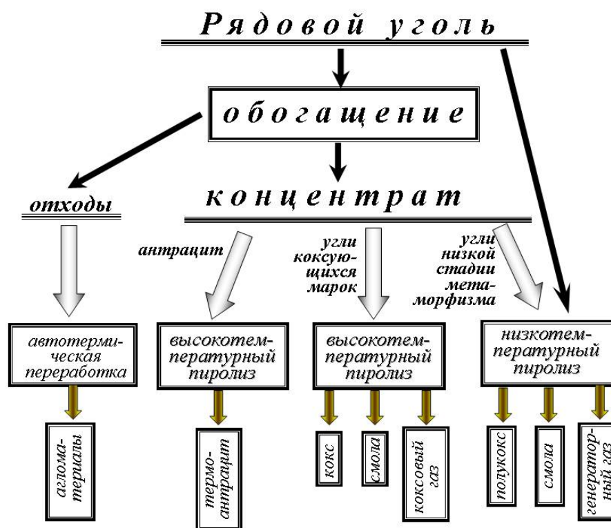
Рисунок 1 – Схема переработки углей
