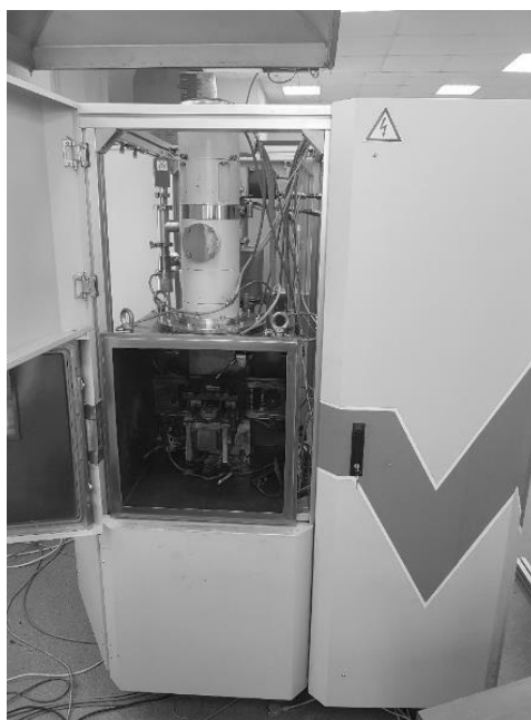
Рисунок 1 - Внешний вид электронно-лучевой установки с модулем наплавки
