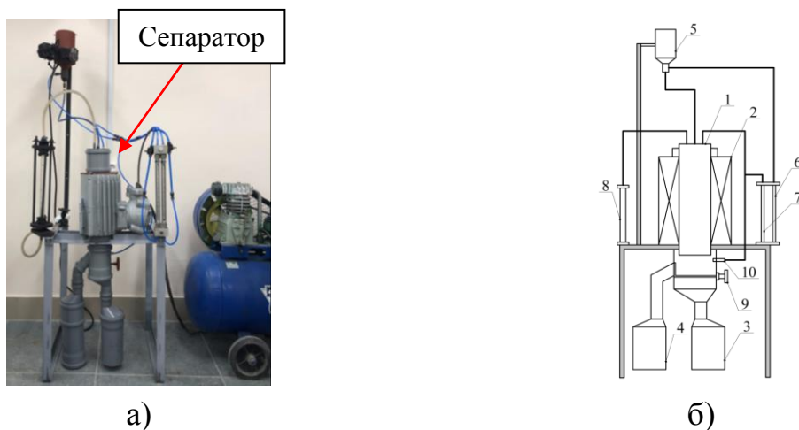
Рисунок 1 - Установка магнитной сепарации железосодержащего концентрата из техногенных отходов: а) общий вид установки; б) схема. Обозначения смотреть по тексту
