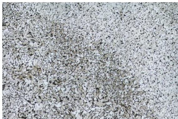
Рисунок 2 - Микроструктура границы ЗТВ с металлом шва образца с увеличением x400
