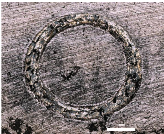
Рисунок 2. Микрофотография трека износа поверхности покрытия
