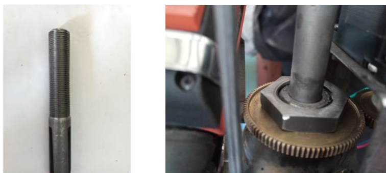
Рисунок 3 – Корпус с резьбой цапгового механизма
