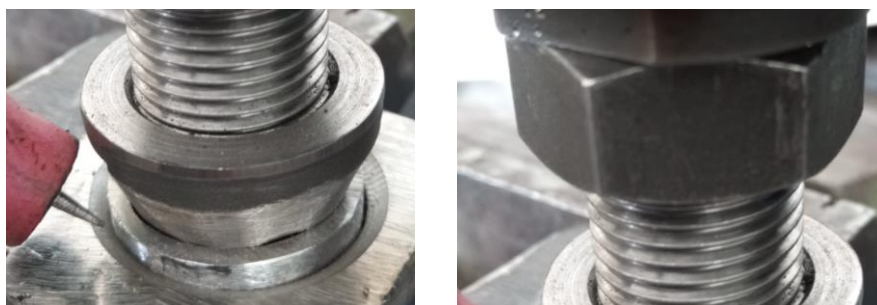
Рисунок 4-Конусообразная шайба для регулирования посадки и контрольная гайка фиксации полки
