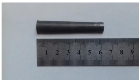
Рисунок 1 – Образец после динамического испытания
