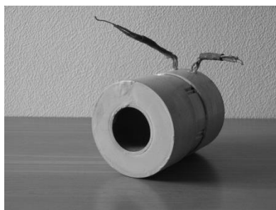
Рисунок 4 – Сформированное покрытие из композитного материала
