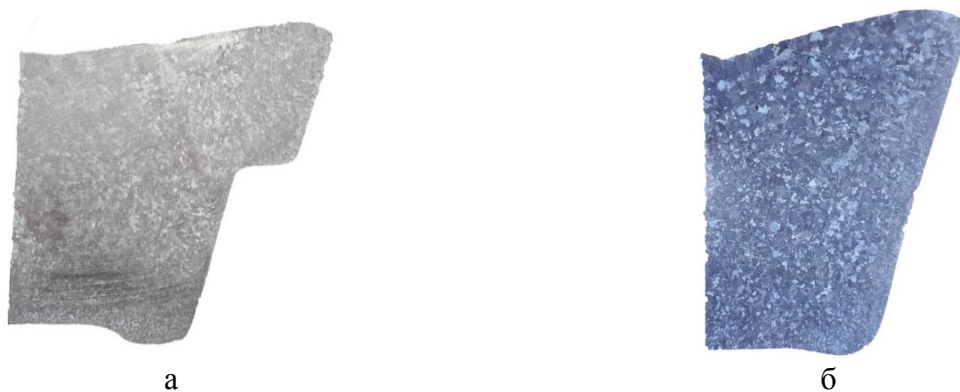
Рисунок 3 - Макроструктура темплетов: а - AlSi7MgSr, б - AlSi7Mg
