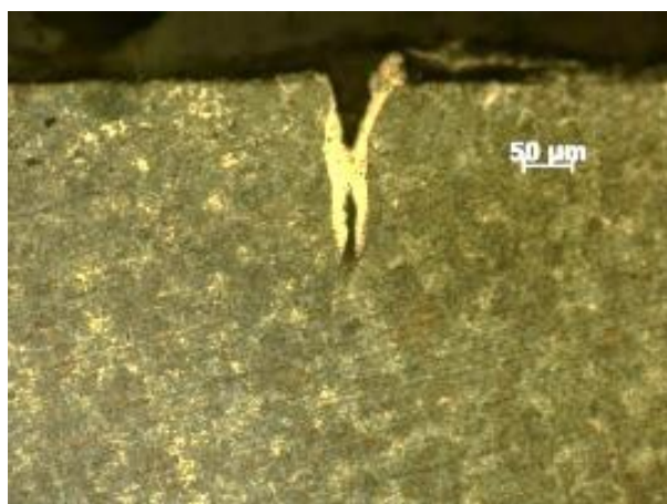
Рисунок 5 – Микроструктура стали при воздействии лазерного излучения с длительностью импульса 100 нс
