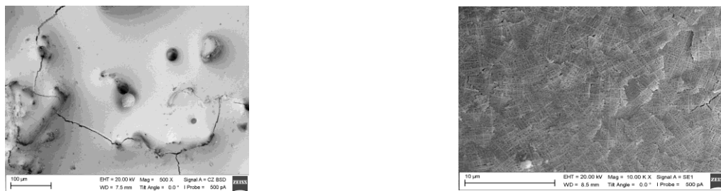
Рисунок 1 - Микрофотографии модифицированной поверхности образцов стали, созданной плазменным напылением порошка ПГСР-4, и последующем облучением интенсивным импульсным электронным пучком при длительности импульса 200 мкс, плотности энергии пучка электронов 20 Дж/см 2 ; количество импульсов воздействия пучка электронов 10
