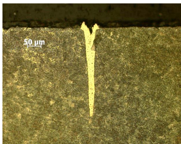
Рисунок 6 - Микроструктура материала в зоне лазерного излучения при перемещении луча со скоростью 1 мм/с (фото сделано поперек направления перемещения луча)
