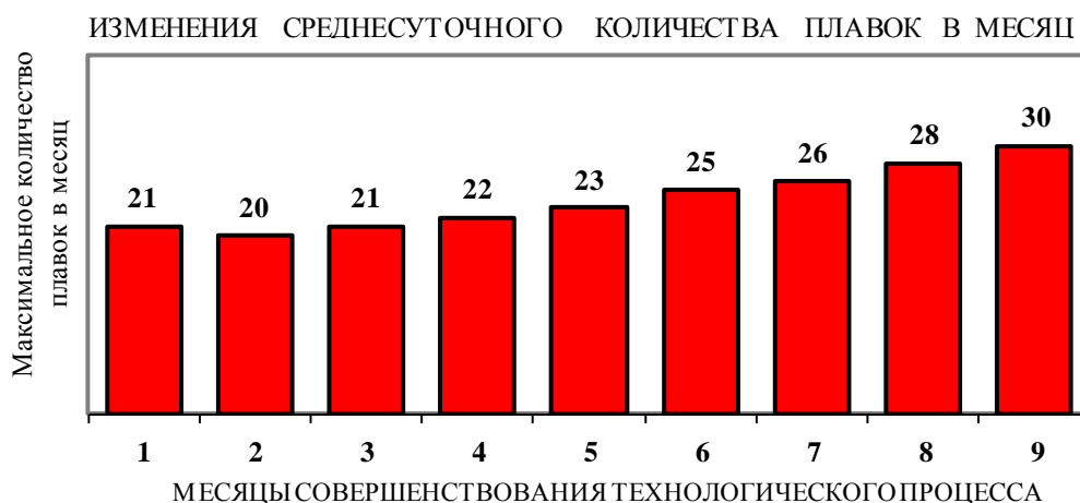
Рисунок 13 - Диаграмма среднемесячной производительности на электродуговой печи постоянного тока садко 150т., в результате оптимизации технологического процесса, использованием информации с системы Accusteel
