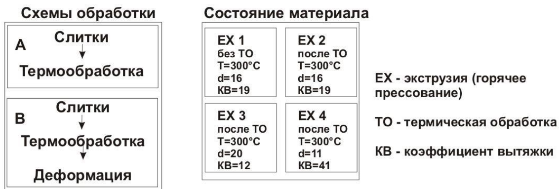
Рисунок 1 - Схемы обработки и состояния материала исследованных магниевых сплавов
