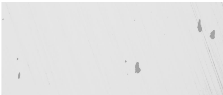
Рисунок 6 - Чечевидные сульфидные включения \text{CaS} \cdot \text{MnS} \cdot \text{FeS}
