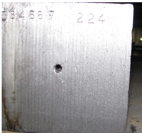
Рисунок 2 – Поперечный разрез заготовки МНЛЗ
