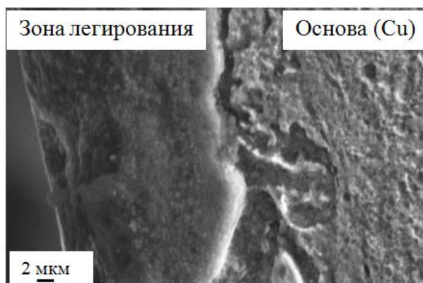
Рисунок 3 – Структурные особенности поперечного сечения титан-бор-медного поверхностного слоя.
