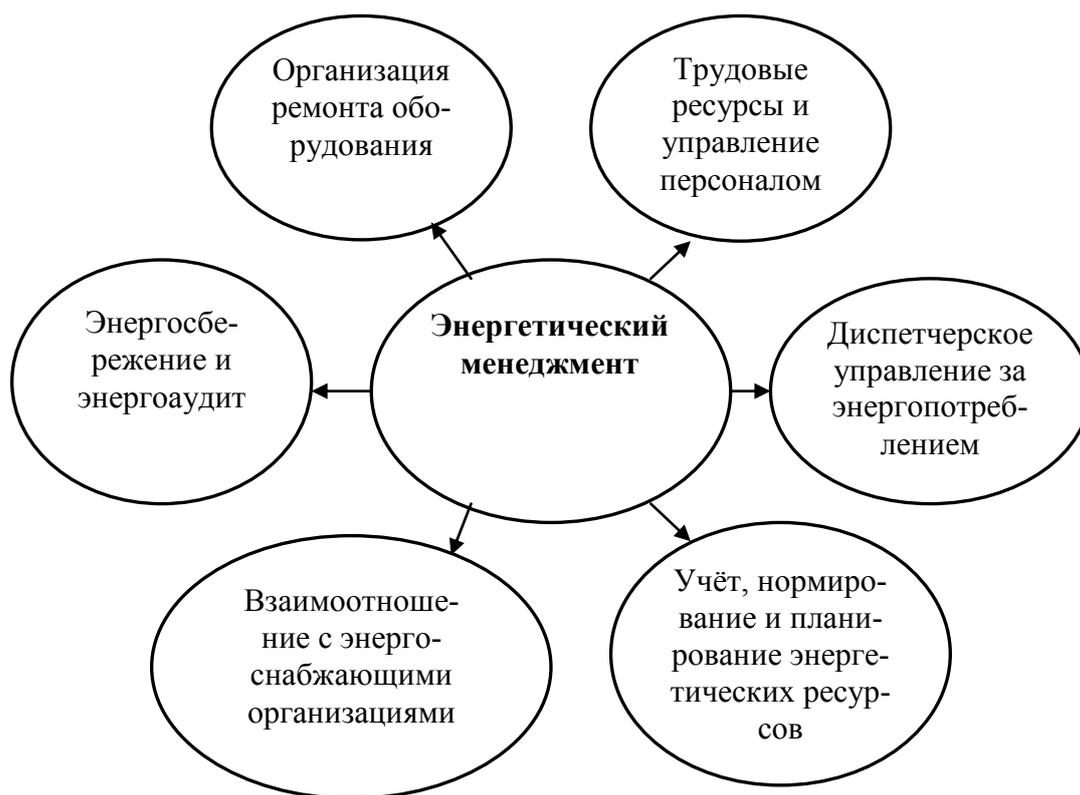
Рисунок 1 – Структурная схема энергетического менеджмента на промышленном предприятии
