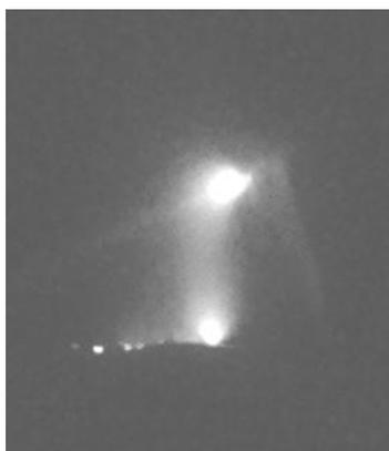
Рисунок 4 – Анодное и катодное пятна электрической дуги
