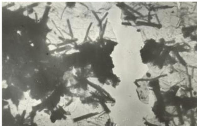
Рисунок 2 – Структура разработанного бесцементного вяжущего
