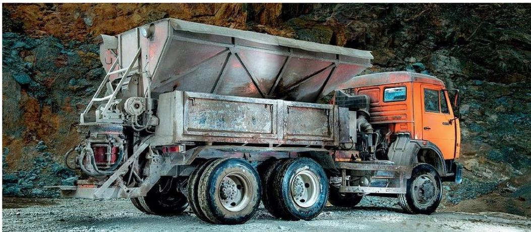
Рис. 5. Механизированный самоходный комплекс для набрызгбетонирования и укладки бетона за опалубку [9]
