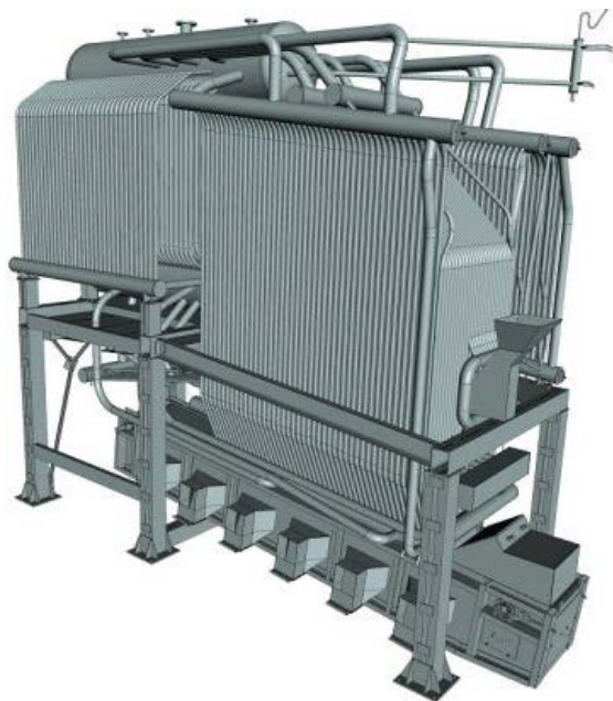
Рис. 2. Паровой котел с высокофорсированной топкой с вихревым дожиганием
