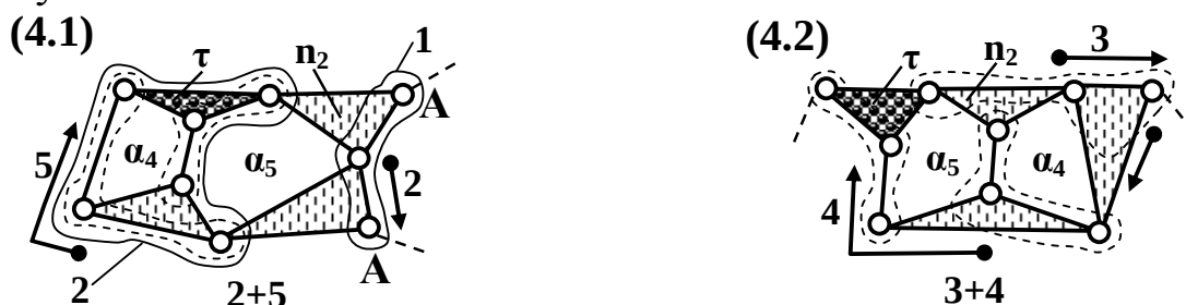
Рисунок 7 – Шестизвенные группы нулевой подвижности с \delta = 3 с двумя замкнутыми контурами \alpha_4 и \alpha_5
