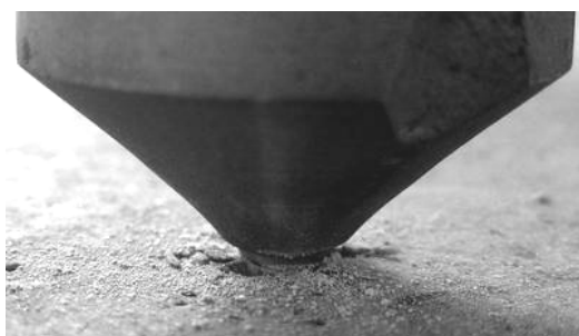
Рисунок 6 – Внедрение в породу одиночного индентора
