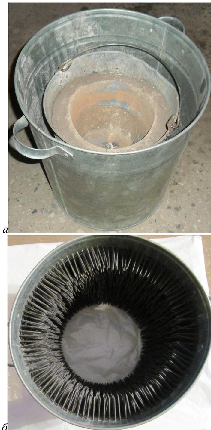
Рисунок 2 – Общий вид отражательного (а) и ворсового (б) экранов
