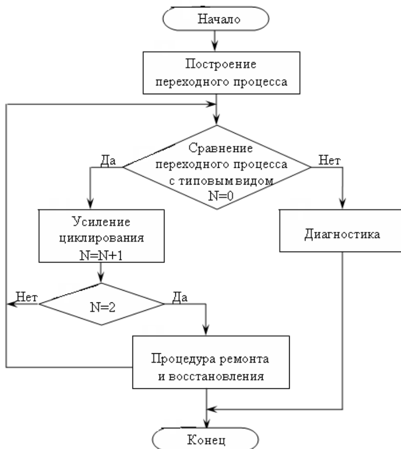
Рисунок 4 – Алгоритм определения разрядной ёмкости и комплектации аккумуляторов в батареи
