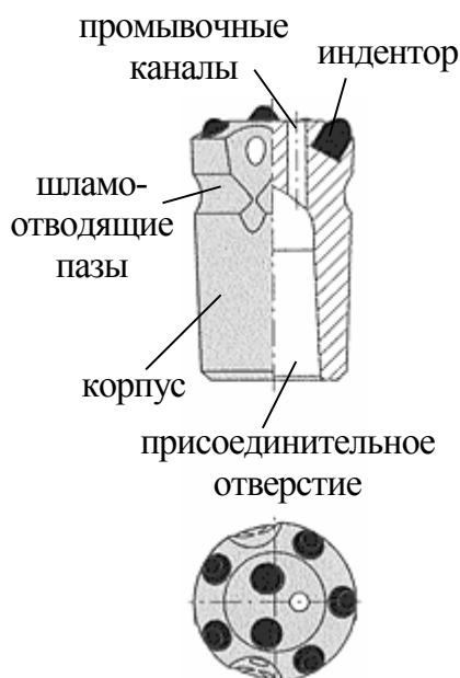
Рисунок 1 – Буровой инструмент безлезвийного типа
