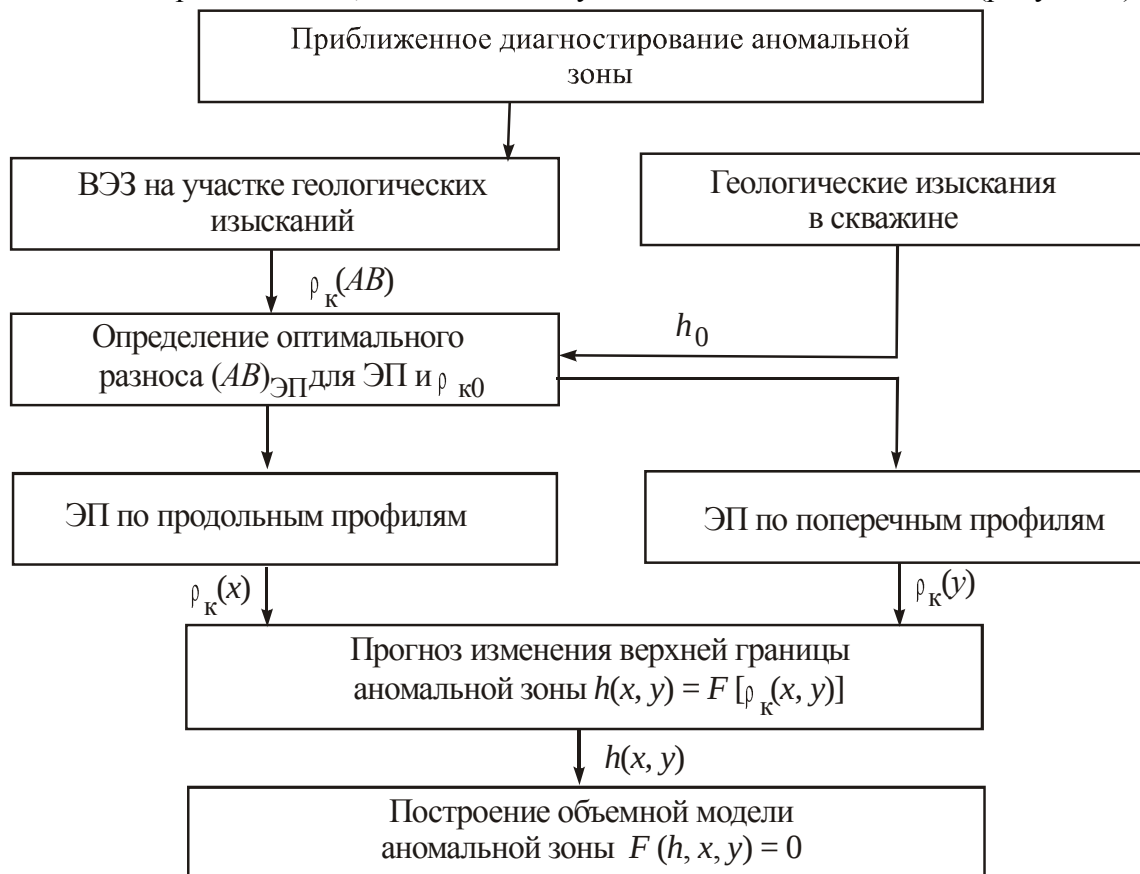
Рисунок 2 - Методика приближенного диагностирования аномальных зон методом электрического зондирования
