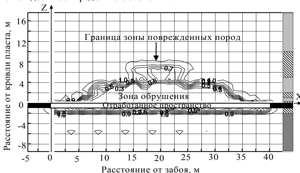
Рисунок 4 – Зона дезинтегрированных пород кровли на основе обобщенного критерия Кулона-Мизеса
