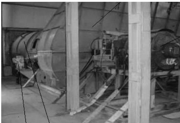
\theta – угол установки лопаток рабочего колеса; T_{рн} , T_p – время реверсирования соответственно вентилятора, расхода воздуха в сети; Q – производительность вентилятора; Q_n , Q_p – расход воздуха соответственно в нормальном и реверсивном режимах, Q_p = 0,94 Q_n Рисунок 5 - Модернизированный вентилятор ВО-24Км на руднике «Ново-Широкинский» (а); осциллограмма реверсирования (б)
