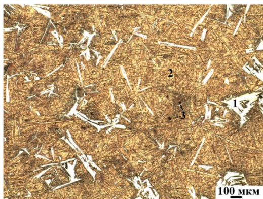
Рисунок – Структура сплава Al–15%Si в исходном состоянии
