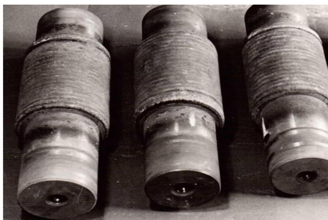
Рисунок – Общий вид наплавленных ПП-P2M8Ю валков для прокатки трансформаторной стали
