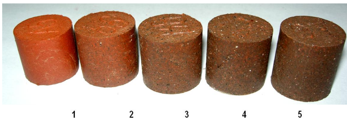
Рисунок 2 – Керамические образцы из новокузнецкого суглинка с добавкой отходов обогащения марганцевых руд: 1, 2, 3, 4, 5 – содержание добавки в количестве 0, 10, 20, 30, 40 мас. %
