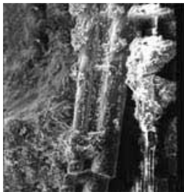
Рисунок 3 – Волокна склеены продуктами новообразований и не имеют коррозионных повреждений
