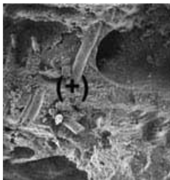
Рисунок 2 – Волокна сшивают матрицу газобетона как арматура и замоноличены в основной связующий материал
