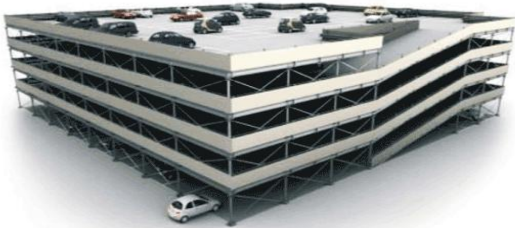
Рисунок 2 – Быстровозводимая модульная парковка Easy Raise
