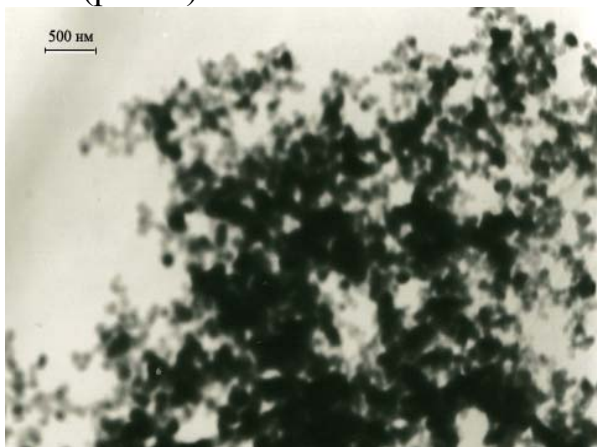
Рисунок 3 – Микрофотография наночастиц серебра, полученных методом химического восстановления танином
