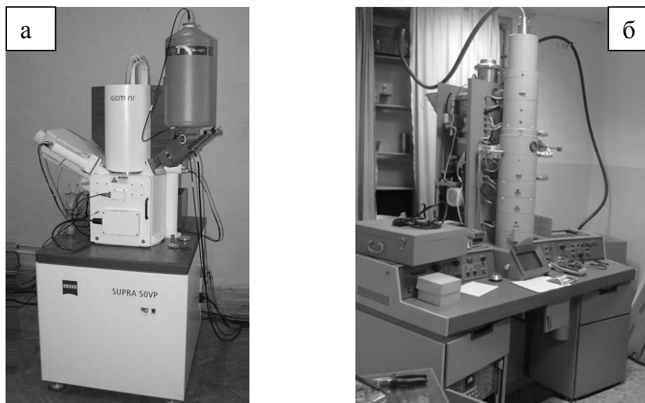
Рисунок – Конструкции современных микроскопов: а) сканирующий электронный микроскоп; б) просвечивающий электронный микроскоп
