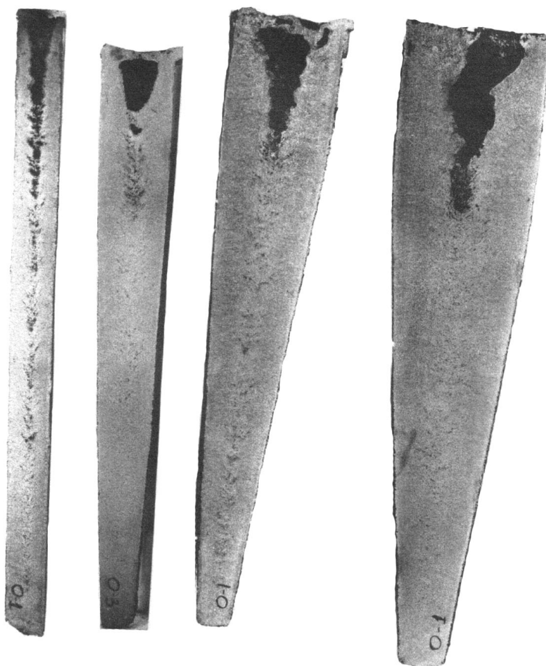
Рисунок – Влияние конусности отливки на глубину усадочной раковины (диаметр внизу 15 мм)
