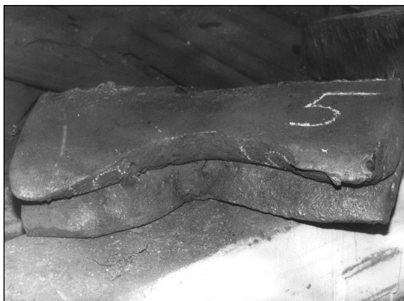
Рисунок 2 – Торцевая утяжка на слябе сечением 140×740 мм, прокатанном на блюминге «1250» ОАО «ЗСМК»
