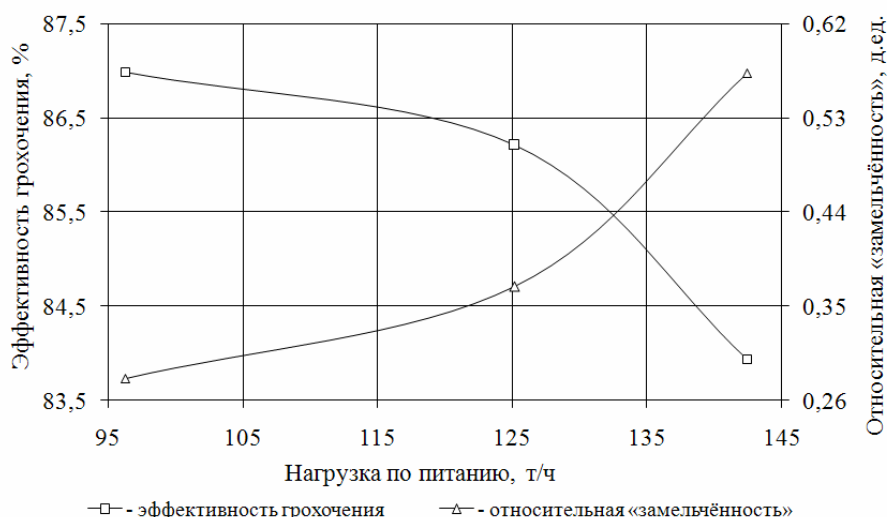
Рисунок 2 – Изменение показателей процесса грохочения в зависимости от нагрузки по питанию
