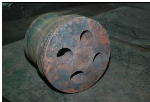
Рисунок 2 – Промышленная конструкция четырехсопловой головки фурмы без сварных швов по внешней чаше для продувки конвертер-ной ванны и нанесения шлакового гарнисажа в 350-тонных агрегатах
