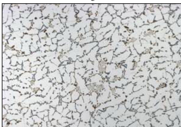
Рисунок 2 – Микроструктура сплава АК7ч с 1,6 % Fe (x500): а – без воздействия тока; б – с воздействием тока ( I = 50 \text{ A} ); в – ТВО и воздействие тока ( I = 30 \text{ A} )
