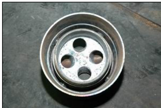
Рисунок 2 – Промышленная конструкция четырехсопловой головки фурмы без сварных швов по внешней чаше для продувки конвертер-ной ванны и нанесения шлакового гарнисажа в 350-тонных агрегатах
