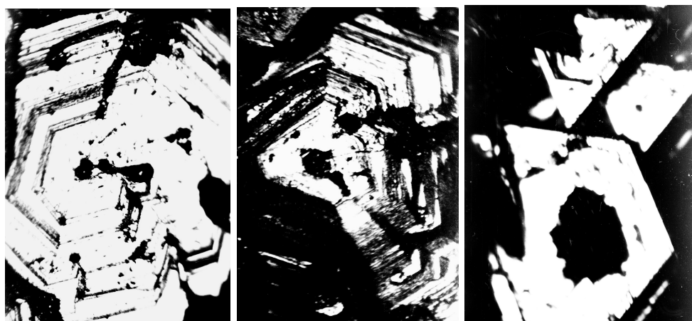
Рисунок 3 – Внешняя форма и скульптура граней титаногалаксита из титано-марганцевого шлака
