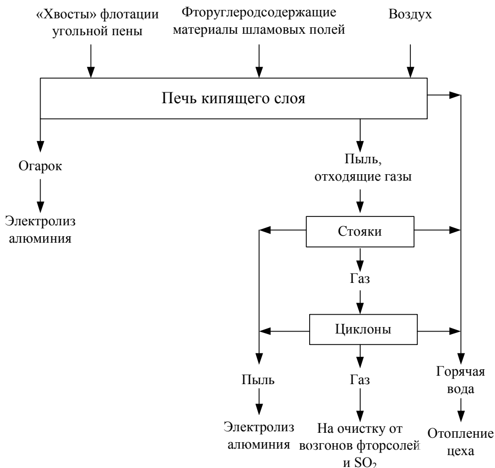
Рисунок – Технологическая схема переработки отходов производства алюминия
