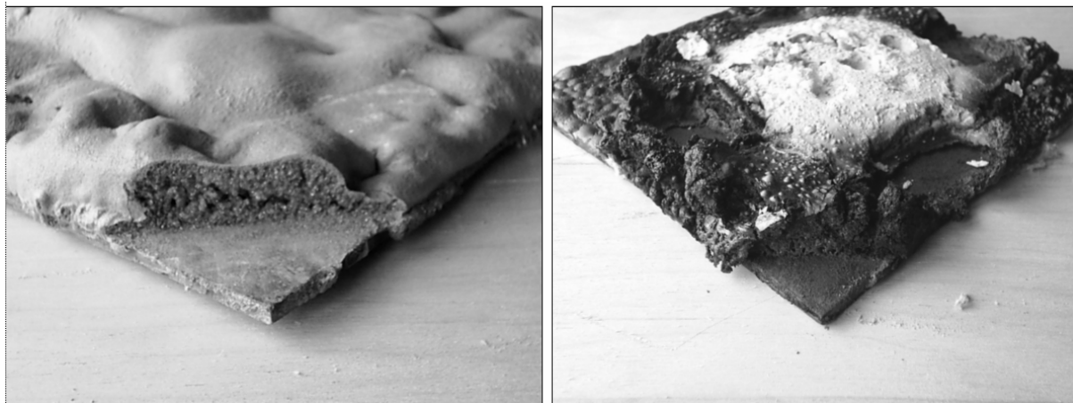
Рисунок 5 – Фотографии пластин после теплового воздействия, защищенных предлагаемым покрытием (а) пастой ОГРАКС-В-СК (б)
