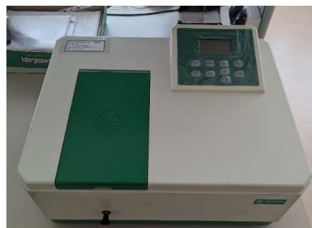
Рисунок 3 – Оборудование для исследования талой воды: а) анализатор вольтамперометрический Та-Lab; б) спектрофотометр ПЭ-5400УФ
