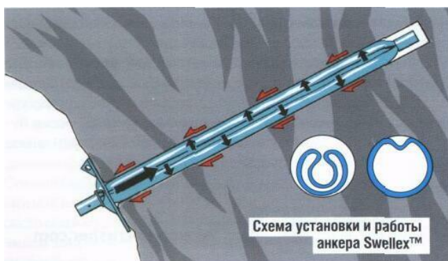
Рисунок 4 – Схема установки и работы анкера Swellex [1]
