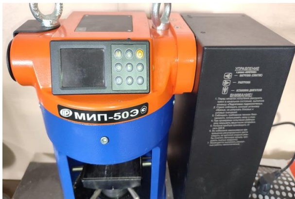
Рисунок 2 – Испытание на прессе МИП – 50Э
