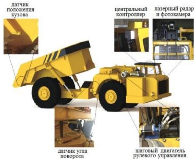
Рисунок 1 – Распределение датчиков для беспилотного вождения [5]
