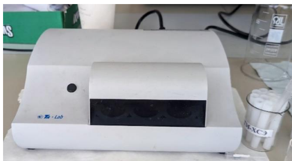
Рисунок 3 – Оборудование для исследования талой воды: а) анализатор вольтамперометрический Та-Lab; б) спектрофотометр ПЭ-5400УФ
