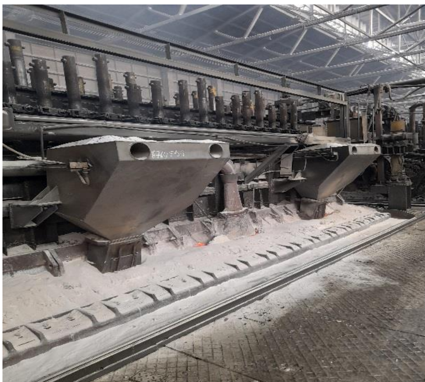
Рисунок 3 – Электролизёр С-2(Э), С-3(Э), оснащённый системой АПС
