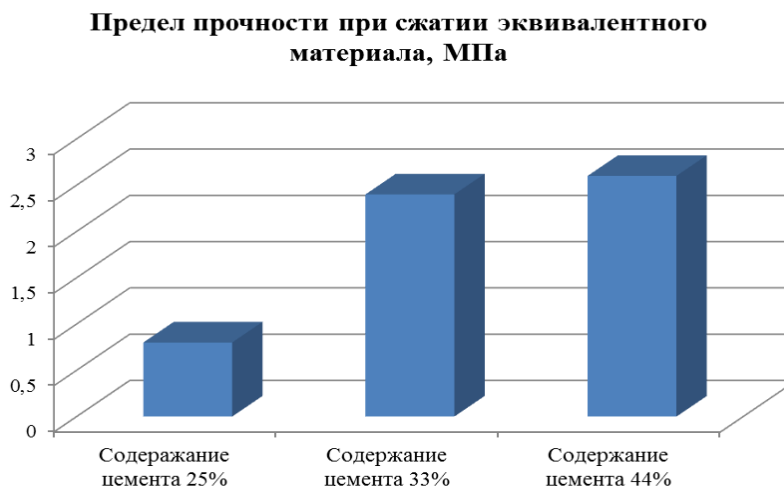
Рисунок 3 – Гистограмма зависимости предела прочности от содержания цемента в смеси
