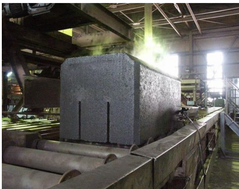
Рисунок 1 - Внешний вид обожжённого анодного блока 1550 мм с пропилами
