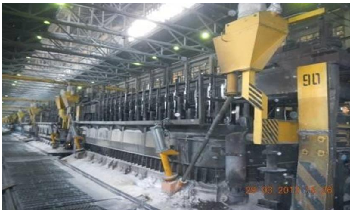
Рисунок 1 – Электролизёр С-8 БМ(Э), оснащённый системой АПС
