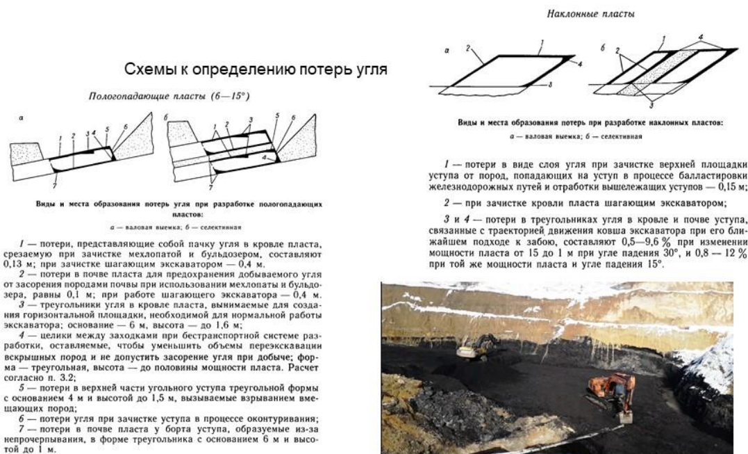
Рисунок 2 – Технические схемы к определению потерь угля
