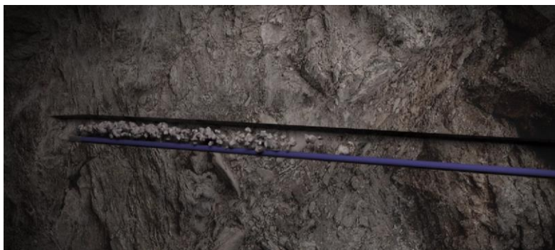
Рисунок 4 – Продувка шпура продувочным шлангом
