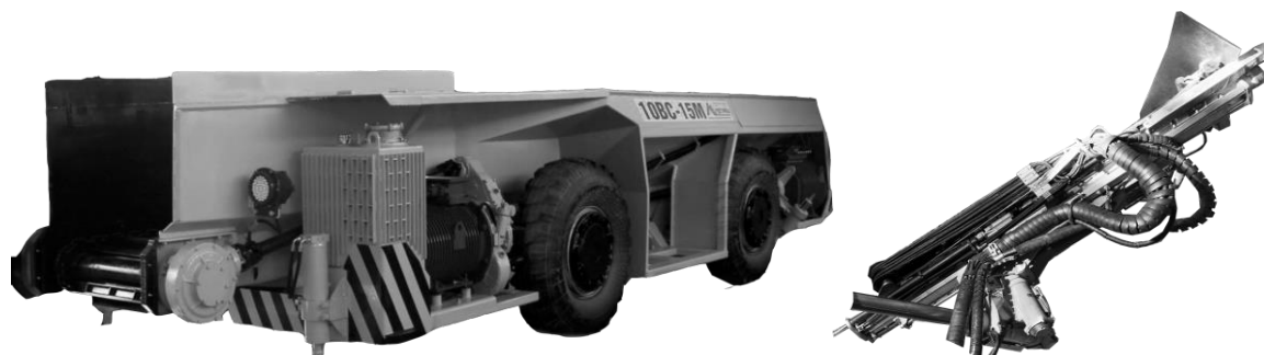
Рисунок 2 – Пример самоходного вагона и навесное буровое оборудование
