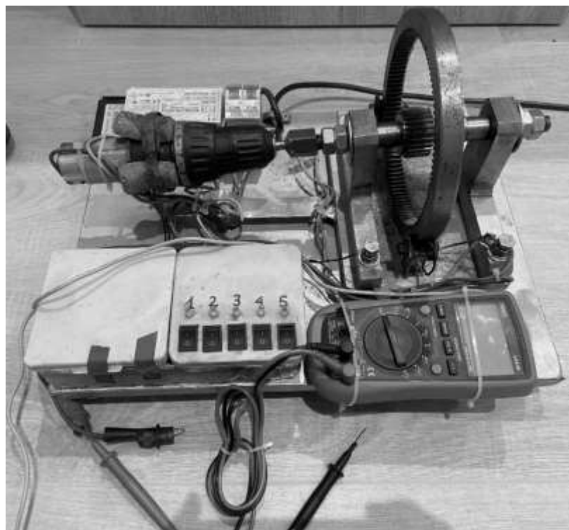
Рисунок 1 – Стенд для исследования контакта зубчатого зацепления колес многосателлитной планетарной передачи.
