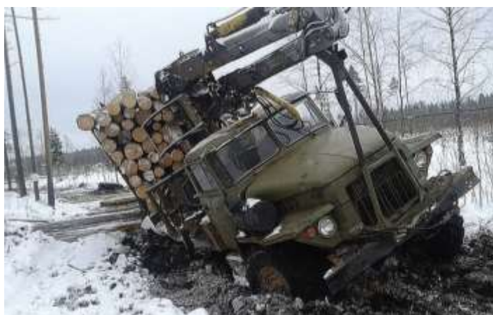
Рисунок – Пример влияния неудовлетворительных дорожных условий на движение лесовозного автомобиля: непроезжаемость лесовозной дороги (Источник: https://news.ati.su/images/2018/11/30/dwqfsben.jpg )
