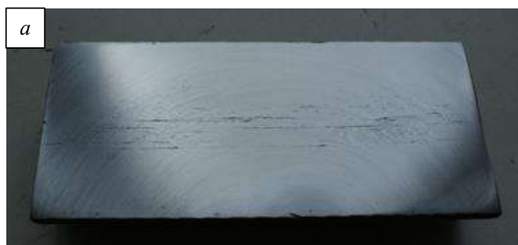
Рис. 3. Флокены в продольных образцах заготовок: а – шлифованные образцы; б – образцы после травления Fig. 3. Floccules in longitudinal samples of workpieces: a – ground samples; b – samples after etching
