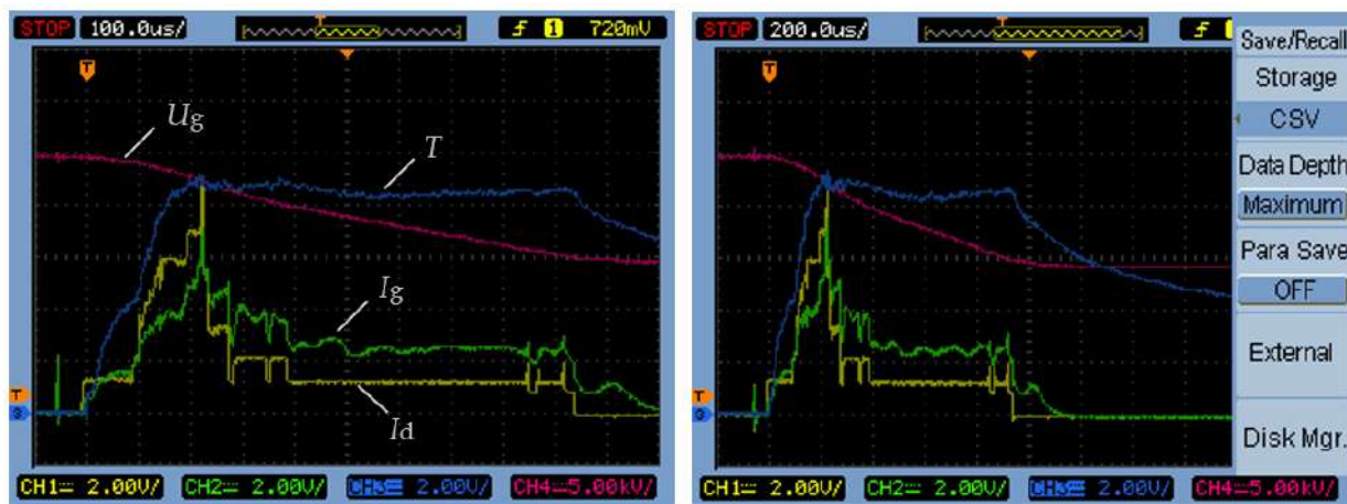
Рис. 3. Характерные осциллограммы тока разряда плазменного катода ( I_d , 40 А/клетка), тока в ускоряющем промежутке ( I_g , 40 А/клетка), ускоряющего напряжения ( U_g , 5 кВ/клетка) и температуры ( T , 400 °С/клетка+ 300 °С)
