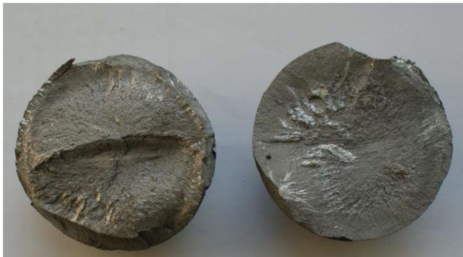
Рис. 2. Излом усталостного характера в шарах, не выдержавших испытания на ударную стойкость Fig. 2. Fatigue fracture in balls, balls that have not passed the impact resistance test
