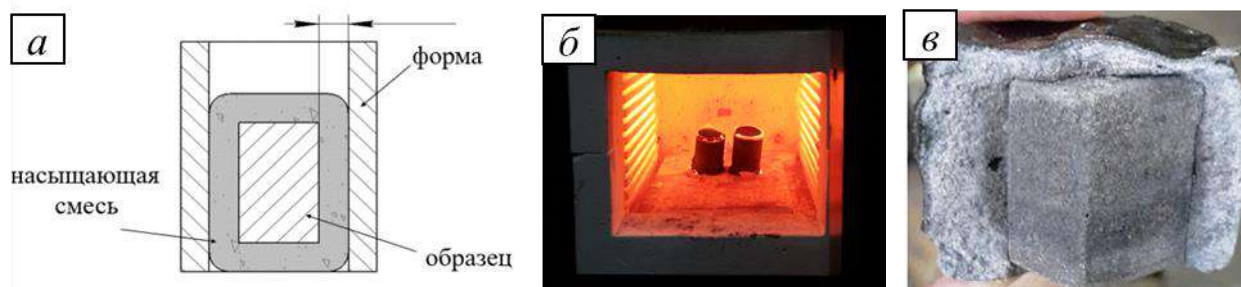
Рис. 1. Схема упаковки (а) и обработки в муфельной печи (б) образцов, а также внешний вид образцов после ХТО (в) Fig. 1. Scheme of packing (a) and processing in a muffle furnace (б) of samples, as well as the appearance of samples after TCT (в)
