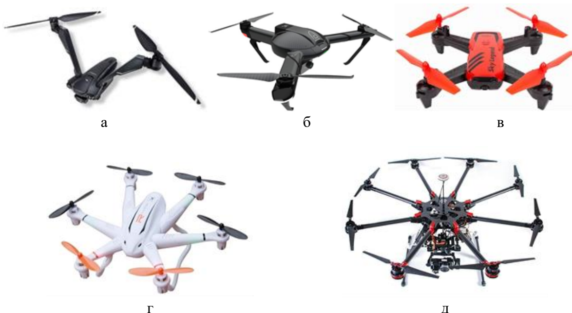
а – бикоптеры; б – трикоптеры; в – квадрокоптеры; г – гексакоптеры; д – октокоптеры
