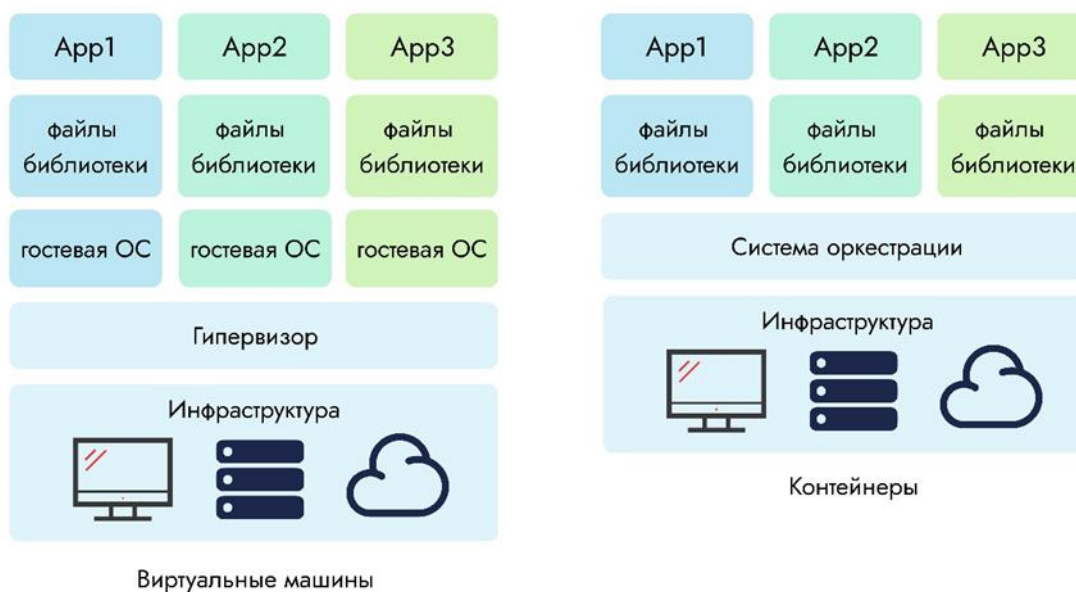
Рисунок 1 – Сравнение устройства виртуальной машины и контейнеров
