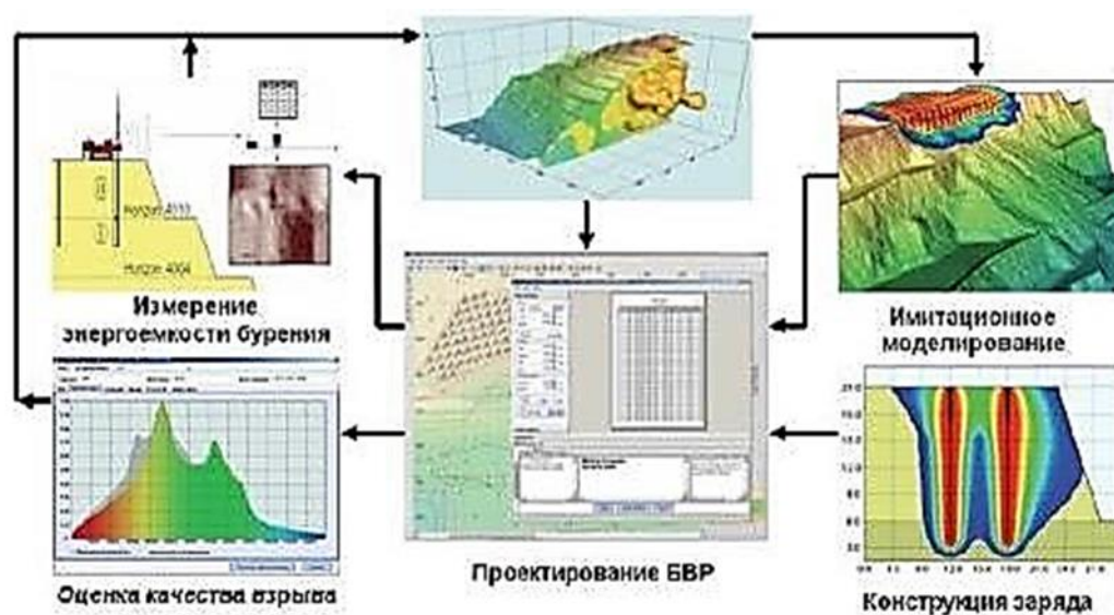
Рисунок 1 – Схема информационных потоков программно-технического комплекса «Цифровой двойник»
