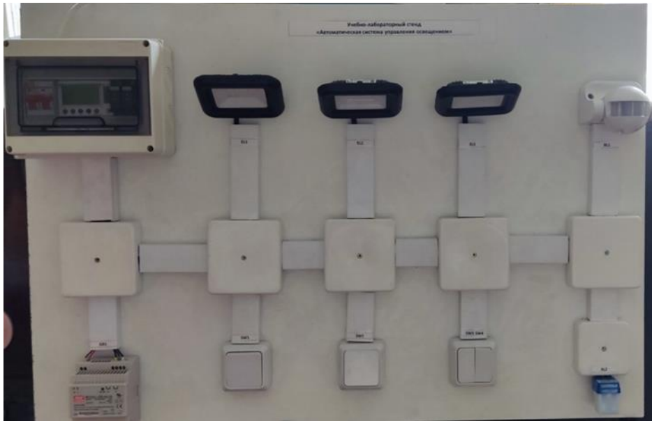
Рисунок 1 – Внешний вид учебно-лабораторного стенда «Автоматическая система управления освещением»
