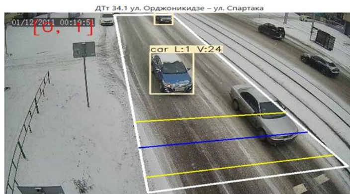
Рисунок 3 – Веб-интерфейс детектора SmartVision-II, установленного на пересечении улиц Орджоникидзе и Спартака г. Новокузнецка
