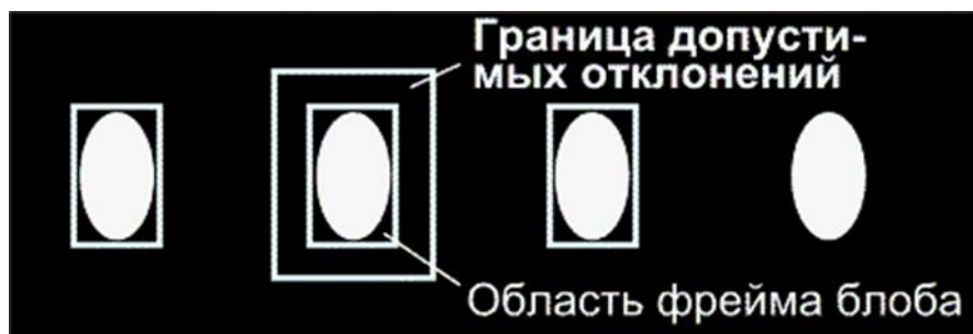
Рисунок 2 – Определение допустимых отклонений дрейфа блоба
