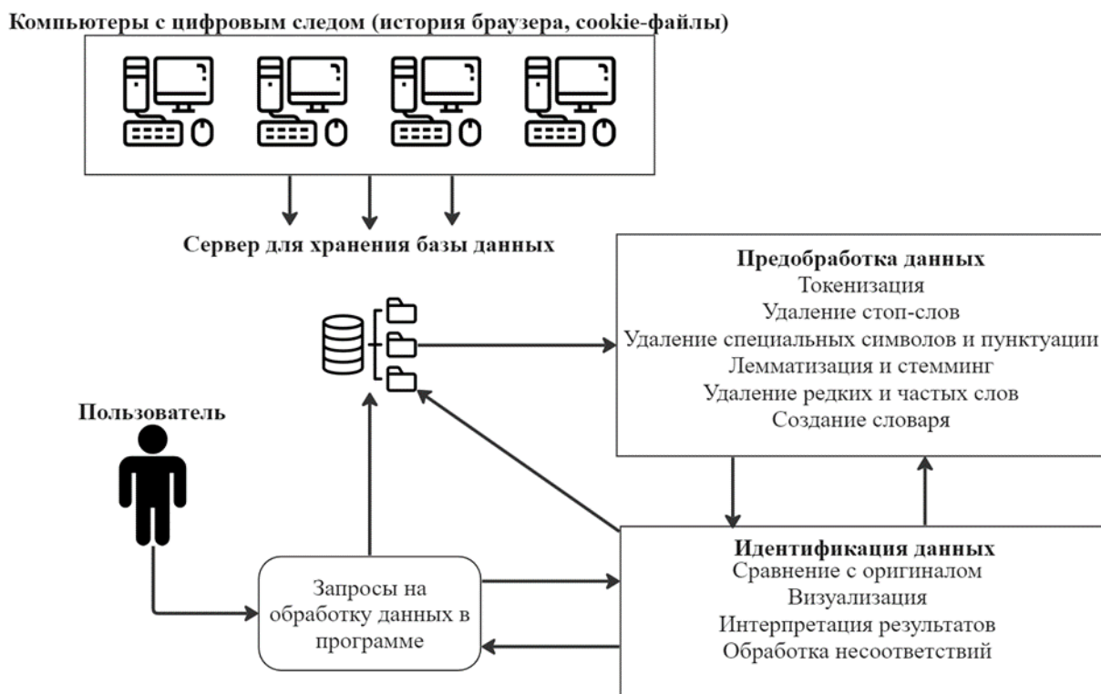
Рисунок 2 – Схема системы сбора и анализа цифрового следа
