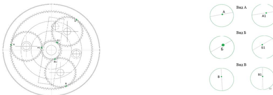
Рисунок 3 – Анализ контакта зацепления зубчатых колес при работе планетарного механизма с уникальным водилом
