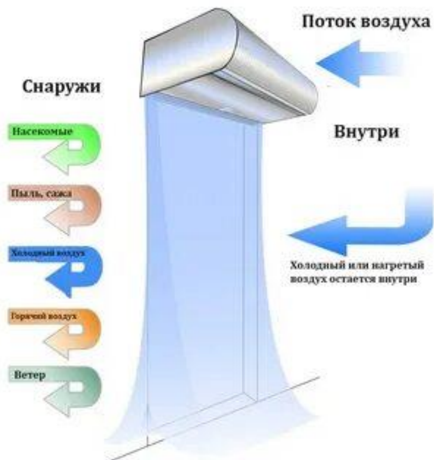
Рисунок 4 – Пример устройства воздушных завес
