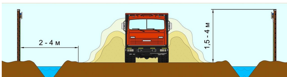
Рисунок 3 – Схема возведения пылеулавливающей завесы
