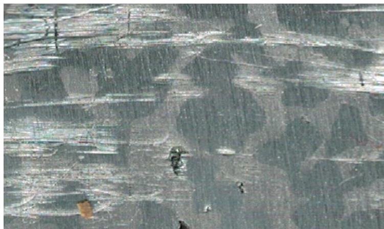
Рисунок 3 - Пористая заготовка- преформа из матричного алюминиевого сплава с размером пор 5 мм пропитанная расплавом цинка
