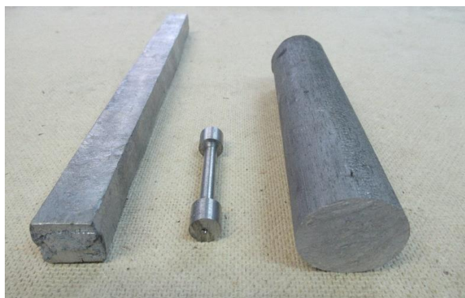
Рисунок 1 – Общий вид кованого и прессованного прутков и образец для определения механических характеристик из легированного силумина
