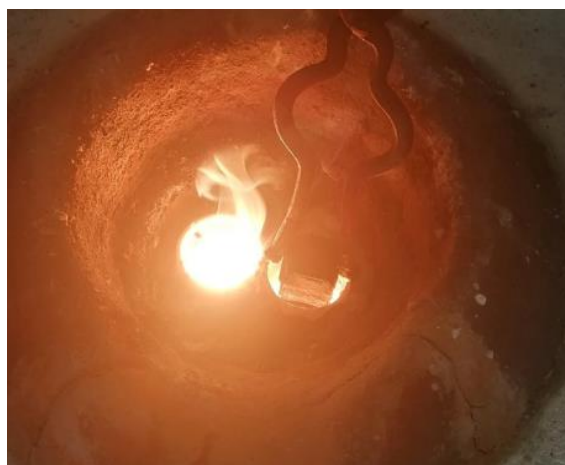
Рисунок 2 – Шихтовка плавки и подвалка металлического лома
