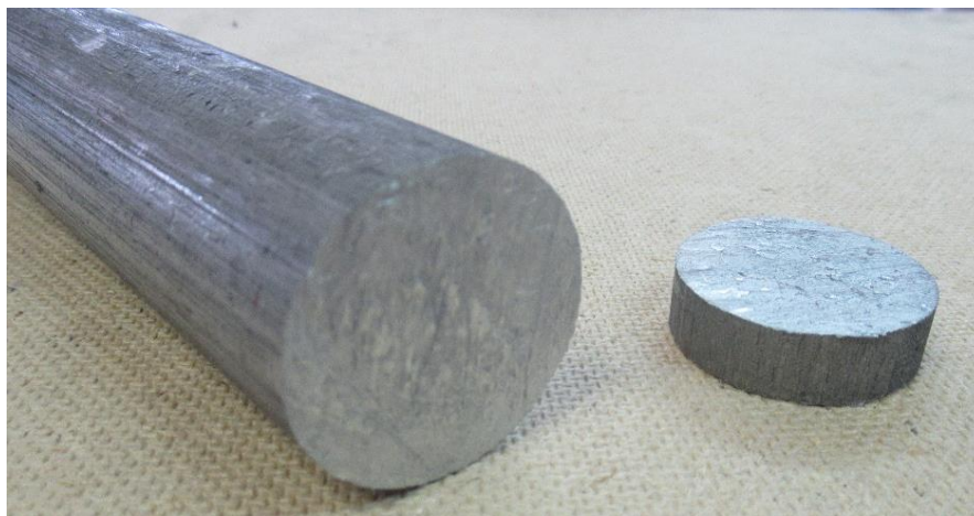
Рисунок 1 – Общий вид прессованного прутка диаметром 57 мм и заготовка для металлографического образца из легированного силумина
