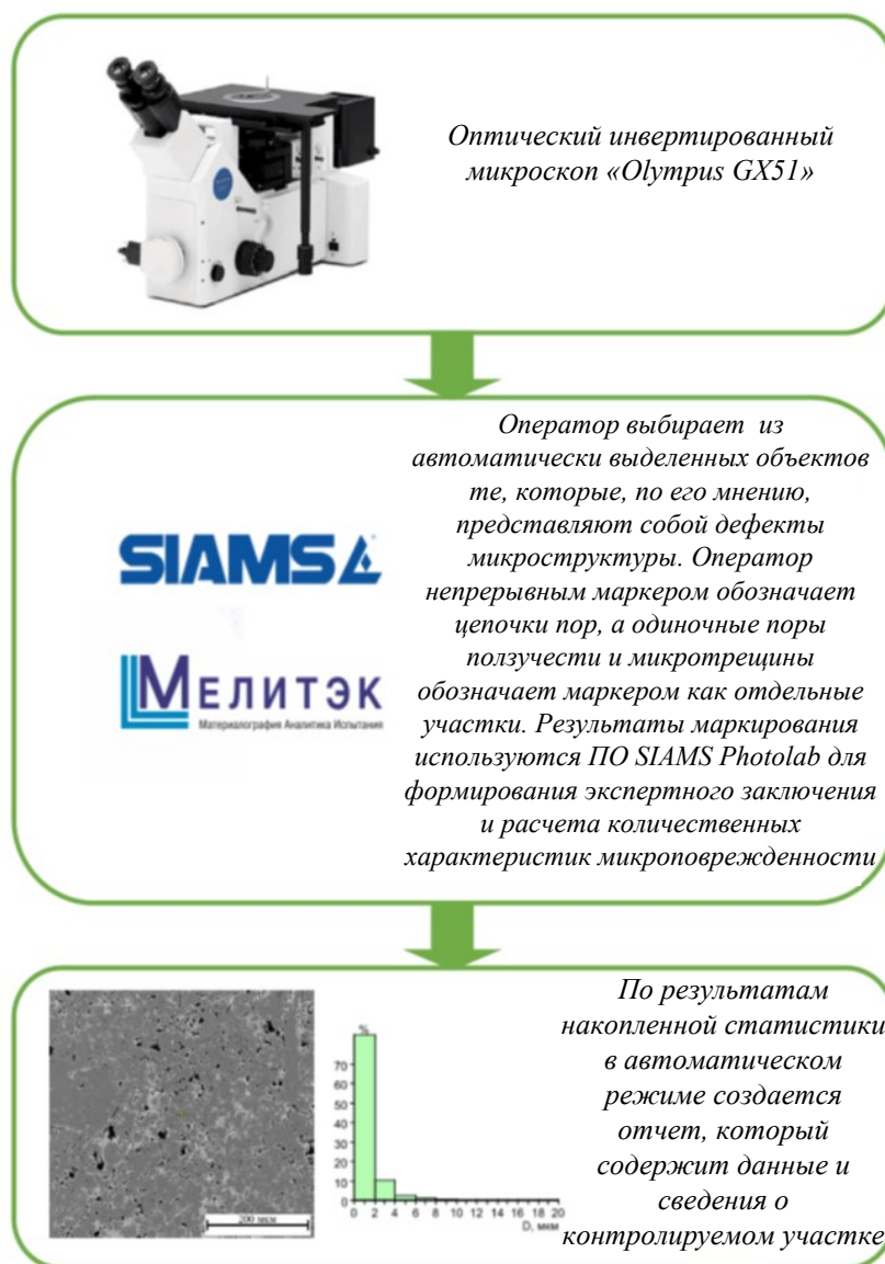
Рис. 2. Блок-схема методики исследования пористости сплавов Fig. 2. Block diagram of the method of studying the porosity of alloys
