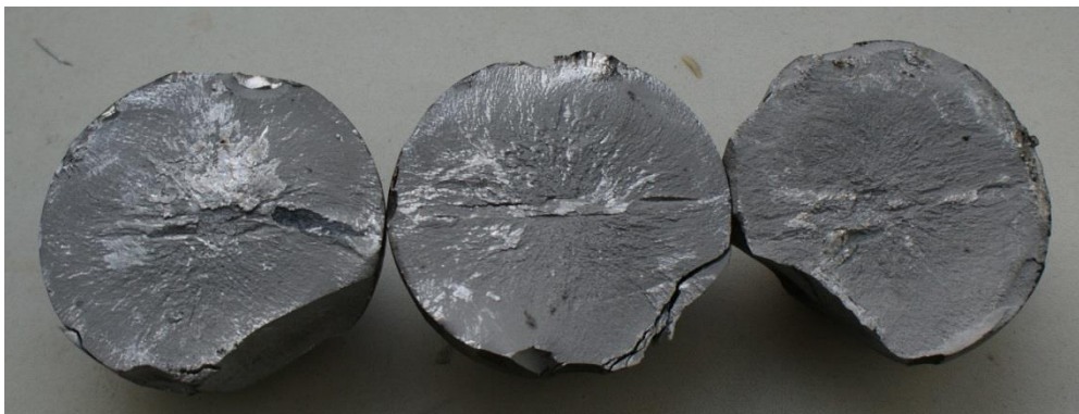
Рис. 2. Флокены в изломе мелющих шаров из стали марки К76Ф Fig. 2. Flocks in the fracture of grinding balls made of steel grade K76F
