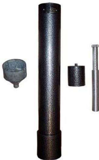
Рисунок 3 – Прибор ПОК-1 для определения крепости горной породы методом толчения по ГОСТ 21153.1-75
