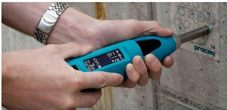
Рисунок 1 – Определение прочности бетона молотком Шмидта [9]
