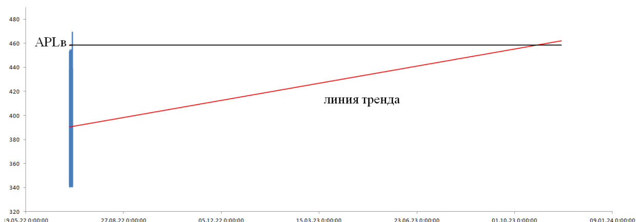
Рисунок 4 – График прогнозирования состояния нагнетателя
