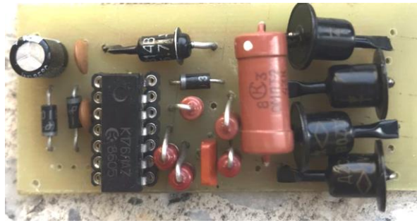
Рисунок 4 – Регулятор мощности паяльника в сборе
