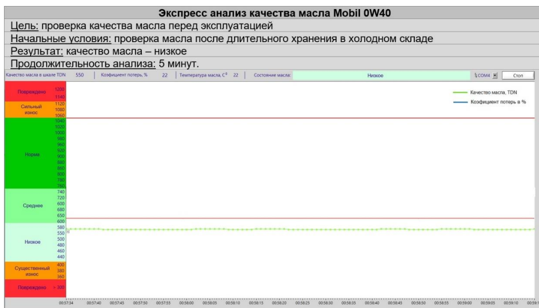
Рисунок 3 – Экспресс анализ качества масла Mobil 0W40 после долгого хранения
