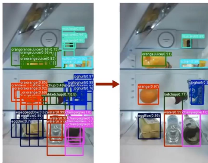
Рисунок 2 – Фильтрация с помощью Non-Maximum Supression
