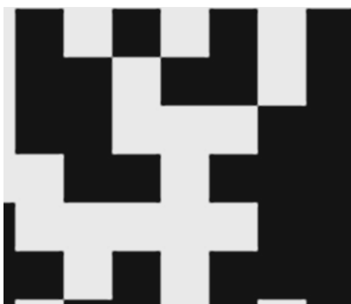
Рисунок 3 – Одна из девяти частей Data Matrix кода после увеличения размера и убирания помех на изображении
