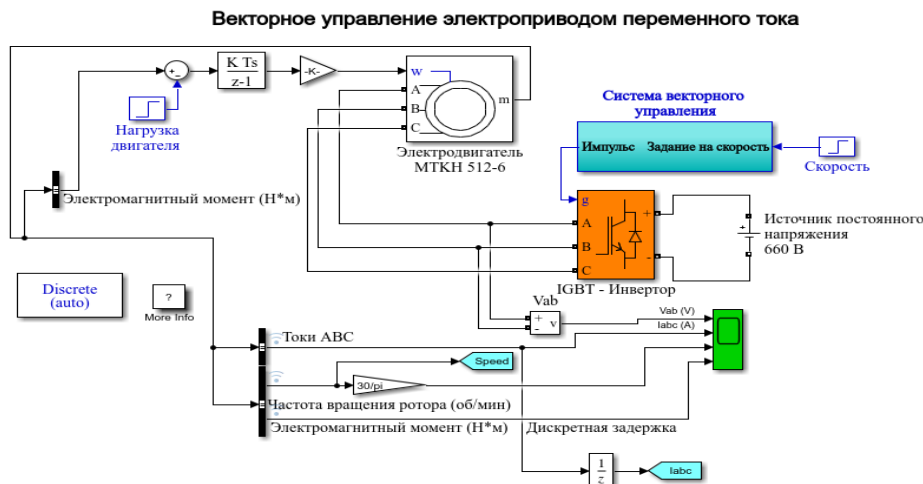
Рисунок 5 – Имитационная модель системы векторного управления однодвигательного электропривода с короткозамкнутым ротором серии МТКН 512-6
