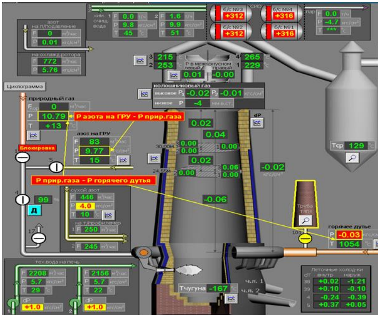
Рисунок 1 – Фрагмент мнемосхемы автоматизированной системы управления доменной печью ЕВРАЗ ЗСМК
