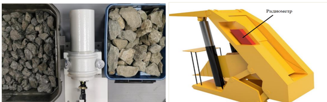
а – процесс измерения с применением радиометра; б – размещение радиометра в выпускном окне лавной секции механизированной крепи для отработки угольных пластов с выпуском
