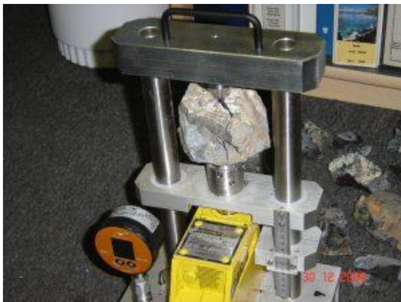
Рисунок 2 – Определение прочности горной породы методом точечной нагрузки [13]
