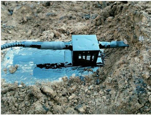
Рисунок 2 – Регистрация сейсмических колебаний с применением цифрового сейсмометра ZET 7156
