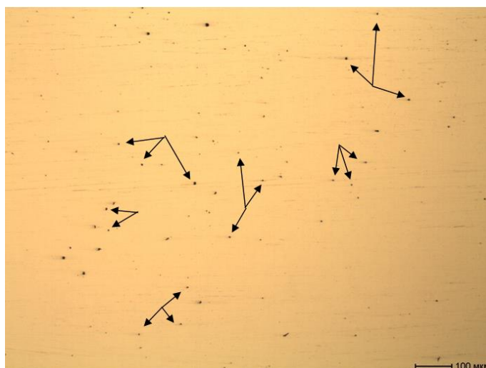
Рисунок 2 – Характерные неметаллические включения в непрерывнолитых заготовках стали 3сп
