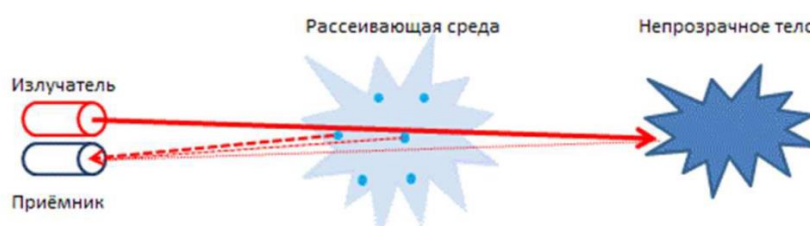
Рисунок 2 – Принцип действия лидара [7]
