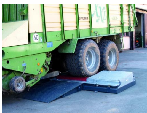
Рисунок 1 – Стенд тестирования тормозной системы автотранспорта
