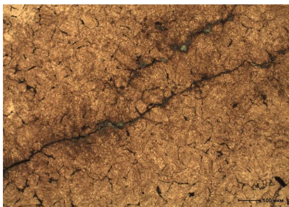
Рисунок 4 – Микротрещина по границам зерен в шаре из рельсовой стали К76Ф, не выдержавшем испытание на ударную стойкость
