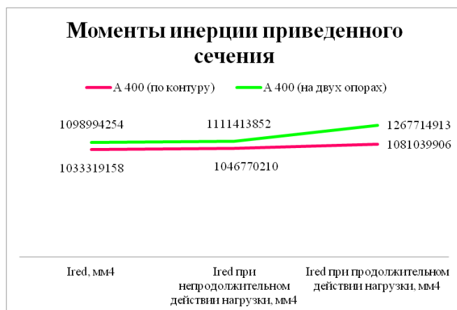
Рисунок 4 – График изменения моментов инерции приведенного сечения в зависимости от типа расчета
