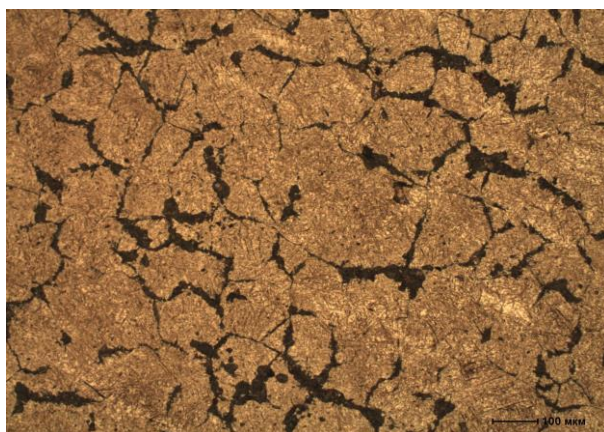
Рисунок 1 – Карбиды цементитного типа в шаре из стали К76Ф, не выдержавшего испытания на ударную стойкость
