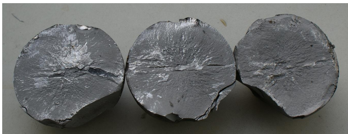
Рисунок 2 – Флокены в изломе мелющих шаров из рельсовой стали К76Ф
