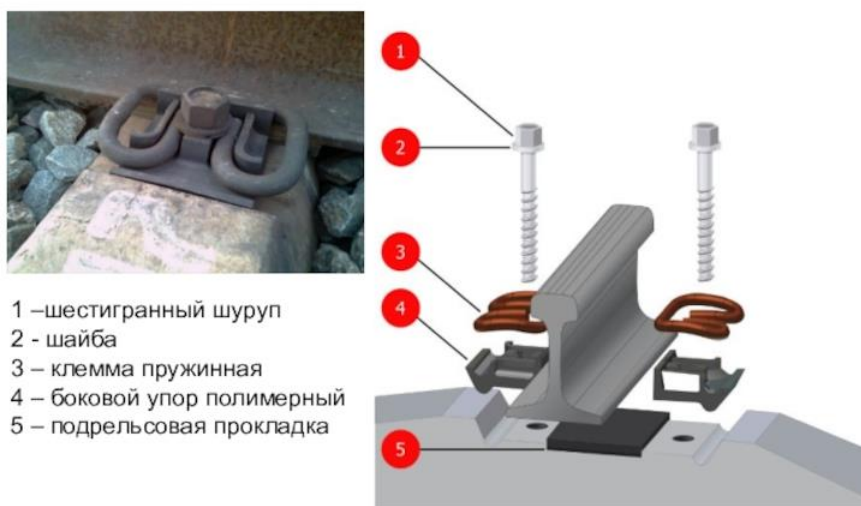
Рисунок 4 – Рельсовое крепление СМ – 1
