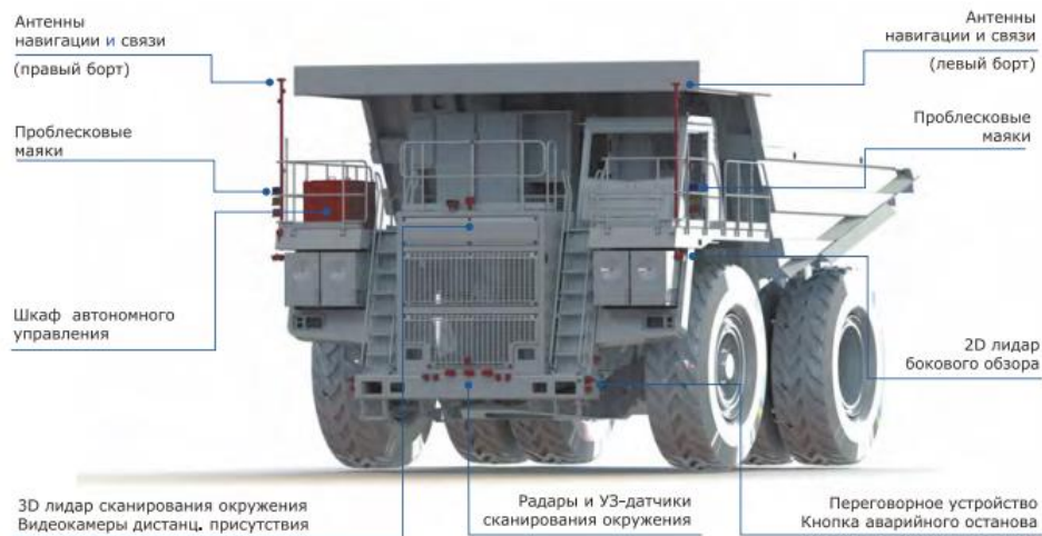
Рисунок 2 – Вариант размещения оборудования на примере БелАЗ 7513 [3]
