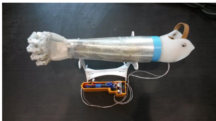
Рисунок 2 - Пример тестирующего бионического протеза
