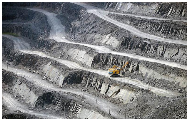
Рисунок 2 - Применение на практике конструкции участка борта с предельной высотой уступов
