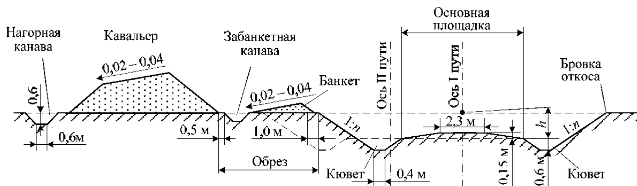
Рисунок 6 – Поперечный профиль земляного полотна железнодорожного пути
