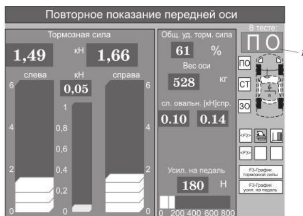
Рисунок 2 – Данные контроля тормозной системы автомобиля: 1 - индикация проверяемой оси; ПО - рабочий тормоз передней оси; СТ - стояночная тормозная система; ЗО - рабочий тормоз задней оси
