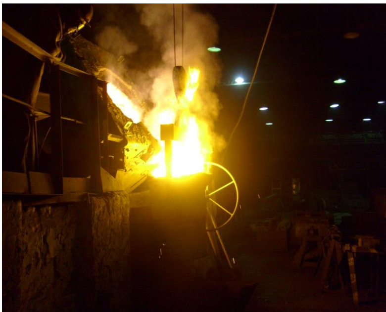
Рисунок 1 - Пылегазовые выбросы при обработке чугуна содой
