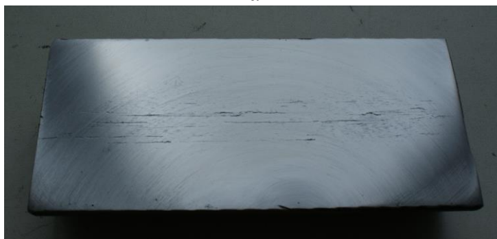
Рисунок 1 – Флокены в продольных образцах катаных заготовок диаметром 50 мм (а) и 60 мм (б)
