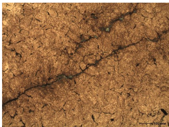
Рисунок 4 – Микротрещина по границам зерен в шаре из рельсовой стали K76Ф, не выдержавшем испытание на ударную стойкость
