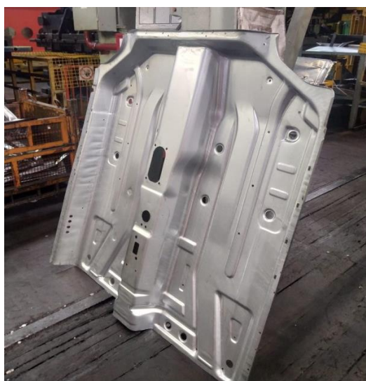
Рисунок 2 - Внешний вид отштампованной детали, полученной из произведенного на НТА-4 горячекатаного травленого дрессированного металла
