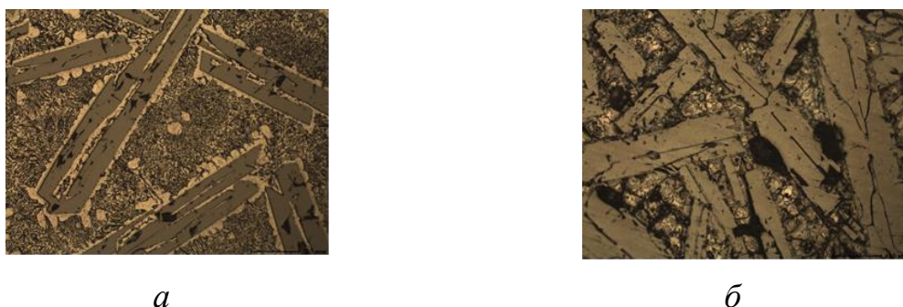
Рисунок 1 – Микроструктура сплавов на основе Al – 40 % Si – Cu x200: a – без Cu ( a ), 40 % Cu ( б )
