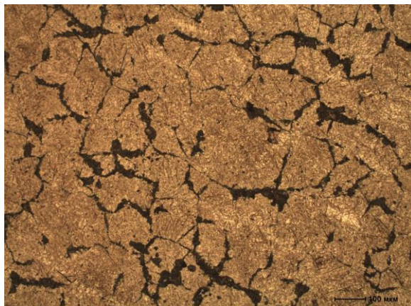
Рисунок 1 – Карбиды цементитного типа в шаре из стали К76Ф, не выдержавшего испытания на ударную стойкость
