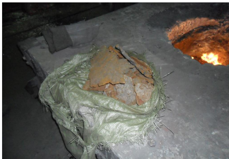
Рисунок 3 - Шихта перед загрузкой в индукционную печь
