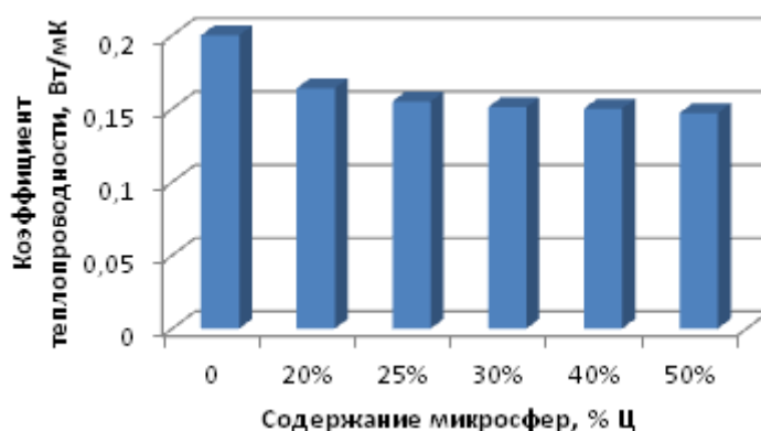
Рисунок 3 – Зависимость коэффициента теплопроводности бетона от количества микросфер
