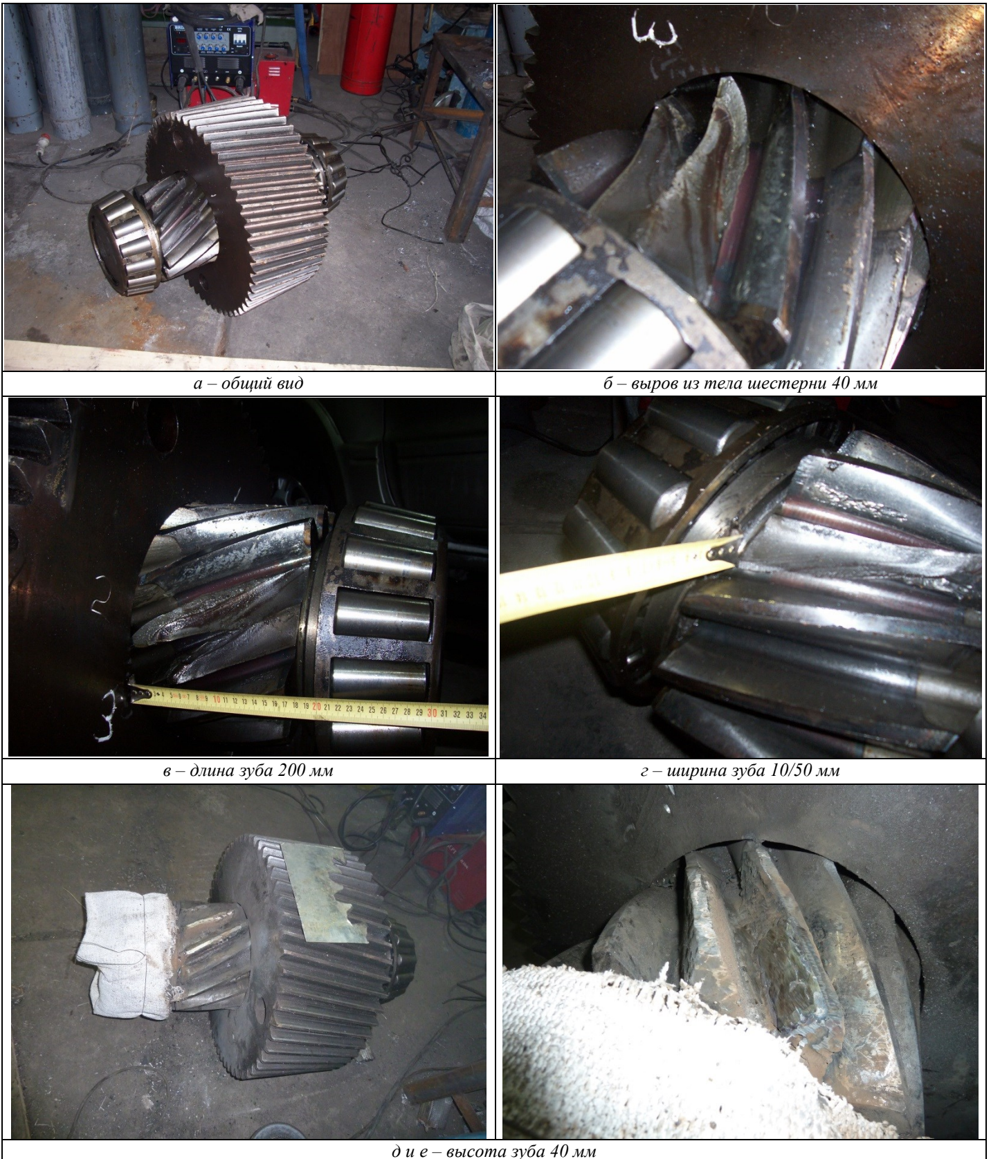
Рис. 4. Восстановление зубьев шестерен сборки редуктора напора экскаватора ЭКГ 5: а – общий вид шестерни; б – выров из тела шестерни 40 мм; в , г – длина и ширина зуба шестерни; д , е – высота зуба шестерни Fig. 3. Restoration of gear teeth of the EKG 5 excavator pressure reducer assembly: а – general view of the gear; б – 40 mm out of the gear body; в , г – the length and width of the gear tooth; д , е – the height of the gear tooth
