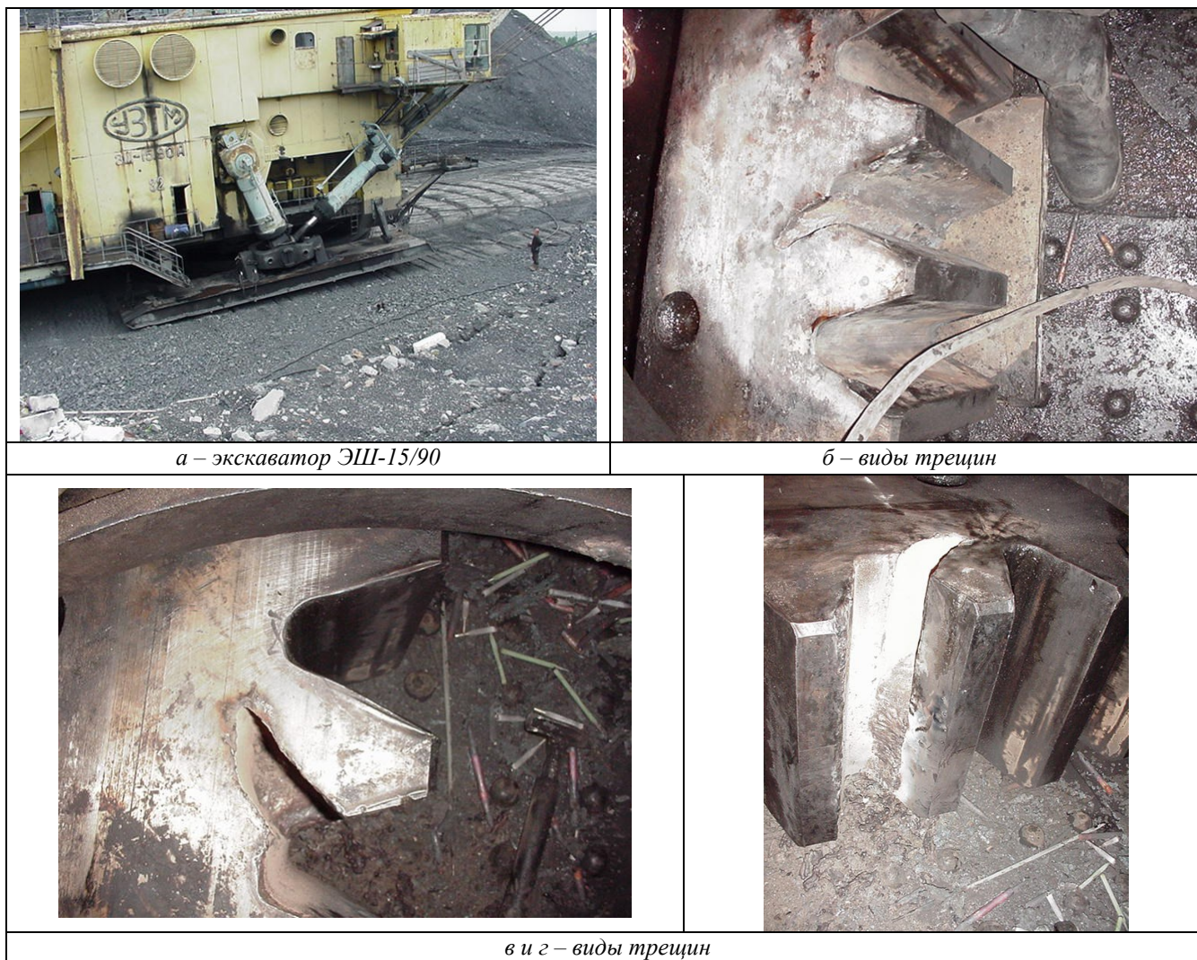
Рис. 3. Общий вид экскаватора ЭШ-15/90 (а) и виды трещин (б – г) Fig. 3. General view of the excavator ESH-15/90 (a) and types of cracks (б – г)
