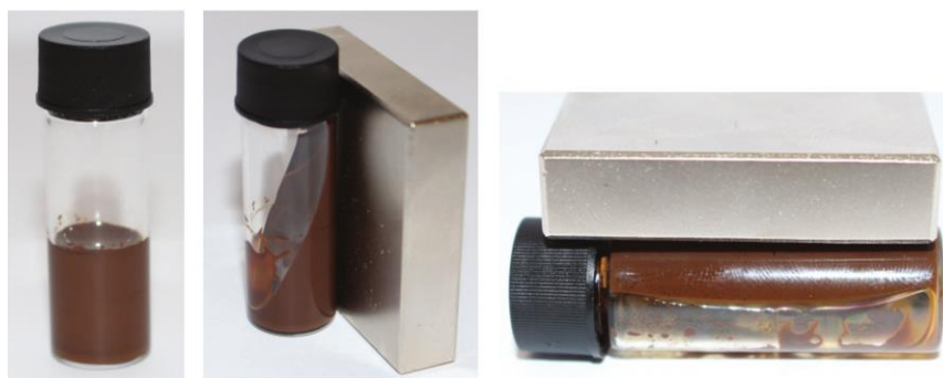
Рисунок 2. Влияние электромагнитного поля на водонефтяную эмульсию [14]
