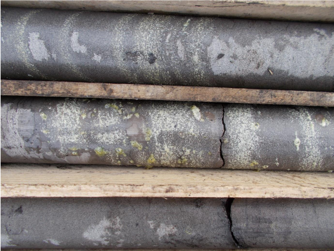
Рисунок 1. Кузбасская нефть в песчаниках, залегающая между угольными пластами 43-42 и 40 на глубинах 590-620 м. (А.М. Афанасьев, 2019 г.)
