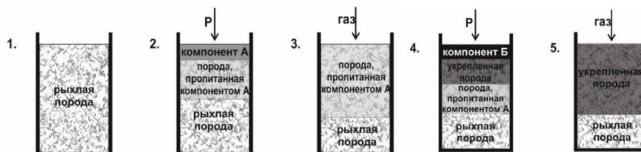
Рис. 2. Схема укрепления горной породы способом покомпонентной закачки компонентов А и Б органоминеральной смолы с дополнительной обработкой газом между этапами нагнетания составов: 1 – размещение породы в испытательной камере; 2 - закачка компонента А полимерного состава; 3 – вытеснение закаченного компонента А вглубь породы сжатым азотом; 4 - закачка компонента Б полимерного состава; 5 - вытеснение закаченного компонента Б вглубь породы сжатым азотом
