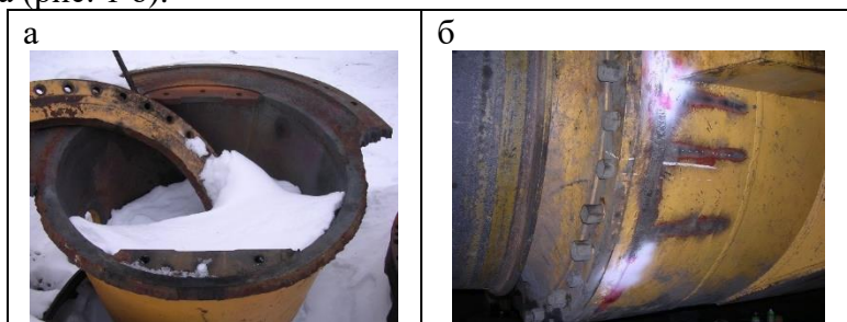
Рис. 1. Разрушенный корпус РМК (а); картер заднего моста после ремонта
