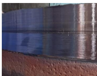
Рис. 2. Наплавленный слой после токарной обработки
