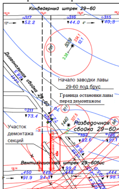
Рис. 1. Выкопировка с плана горных работ пласта 29а
