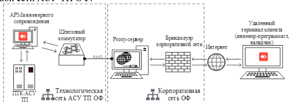
АРМ – автоматизированное рабочее место; ПТК – программно-технический комплекс Рис. 4. Организация сетевой структуры RDP-подключения к АСУ ТП ОФ «Шахта №12»
