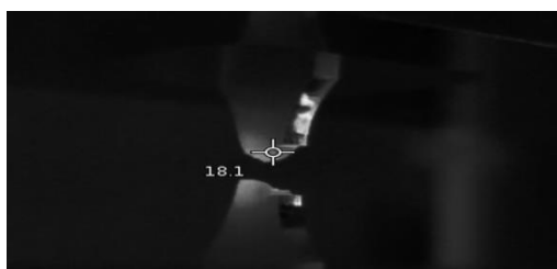
Рисунок 3 - Термограмма образца из стали Ст3сп5 в момент разрушения
