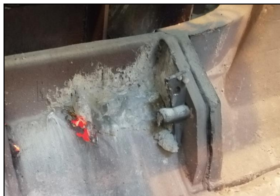
Рисунок 2 – Прогар чугунных секций ГСК
