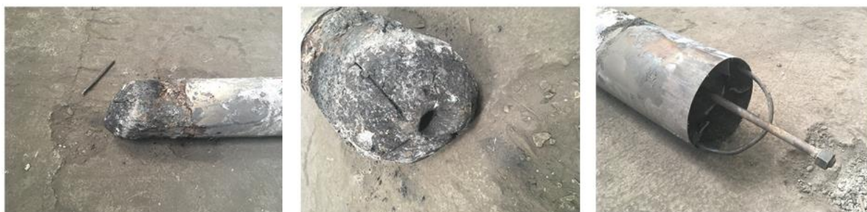
Рисунок 1 – Фотографии самоспекающегося электрода
