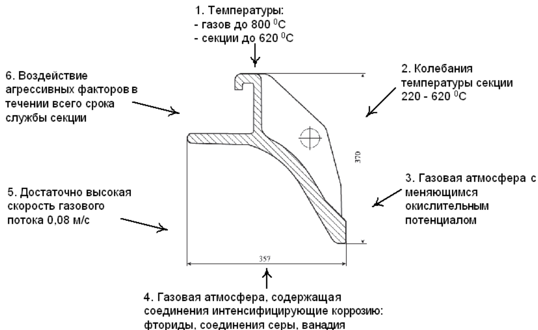
Рисунок 3 – Факторы, способствующие интенсивной высокотемпературной газовой коррозии чугунных секций ГСК
