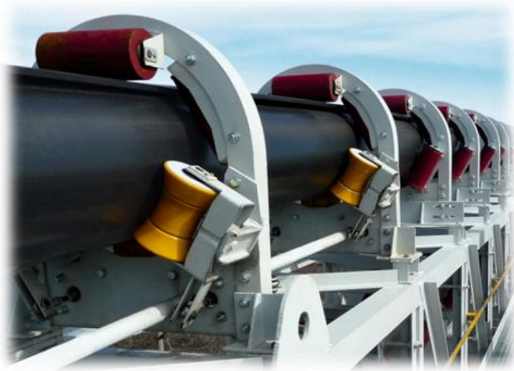
Рисунок 2 – Трубчатый ленточный конвейер
