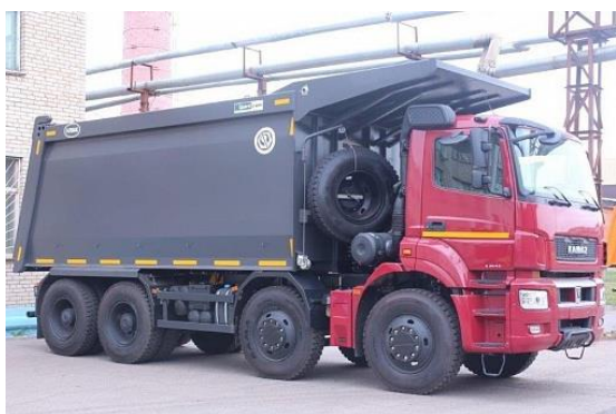
КамАЗ Самосвал углевоз 65801-Т5, грузоподъемность 31 т
