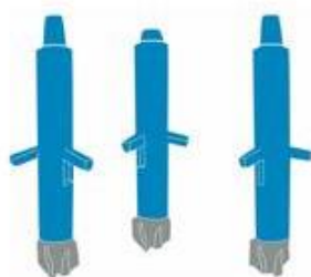
Рисунок 2- Расширитель скважин для мягких и средних пород [5]
