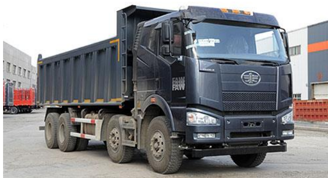
Самосвал углевоз FAW 3310 8x4, грузоподъемность 33 т
