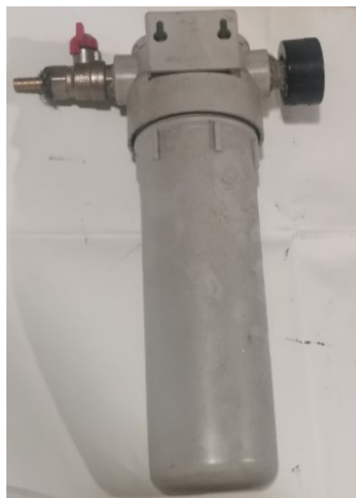
Рис. 2. Герметичный сосуд для отбора проб угля Fig. 2. Sealed vessel for coal sampling
