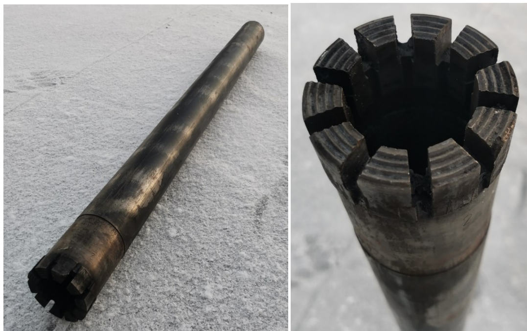
Рис. 1. Угольный керноотборник для отбора угольных проб в условиях горных выработок Fig. 1. Coal core barrel for coal sampling in mine workings
