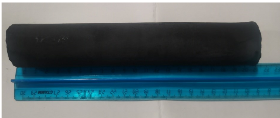
Рис. 4. Угольный керн, отобранный с помощью шахтного керноотборника Fig. 4. Coal core sample taken using mine coring machine
