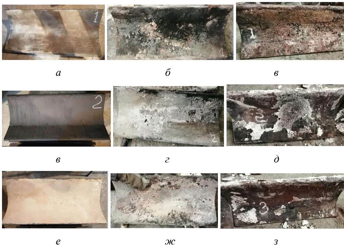
Рисунок 1 – Секции с покрытиями и композитные: после изготовления (а, в, е), осмотра 11.03.2020 г. (б, г, ж), 13.08.2020 г. (в, д, з):
