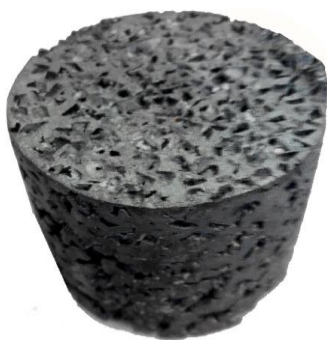
Рисунок 2– Пористая заготовка из маточного сплава для ввода в поры ультра- и наноматериалов
