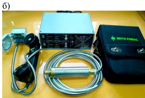
Рисунок 1 - Система акустического контроля состояния горного массива и прогноза динамических явлений САКСМ: а) - персональный компьютер, с программным обеспечением АКМП-РИВАС для обработки и анализа сигнала; б) - аппаратура регистрации и передачи на поверхность акустического сигнала АРАС
