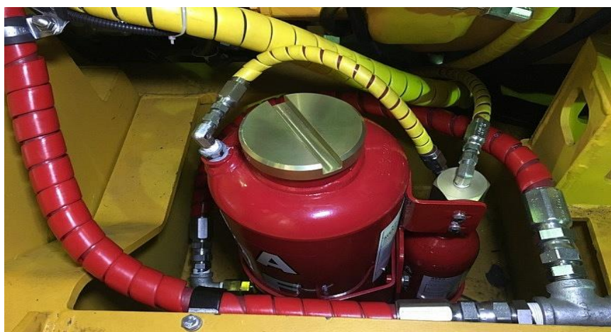
Рисунок – Система пожаротушения шахтного самосвала [2]
