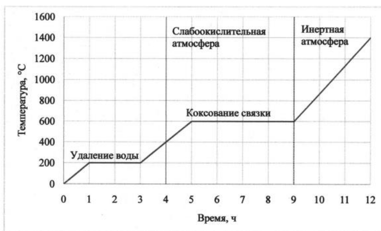
Рисунок 4 - температурный режим сушки и подогрева углеродсодержащей футеровки
