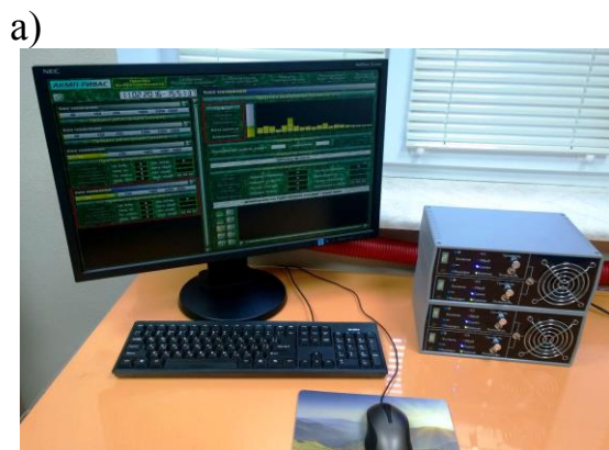
Рисунок 1 - Система акустического контроля состояния горного массива и прогноза динамических явлений САКСМ: а) - персональный компьютер, с программным обеспечением АКМП-РИВАС для обработки и анализа сигнала; б) - аппаратура регистрации и передачи на поверхность акустического сигнала АРАС
