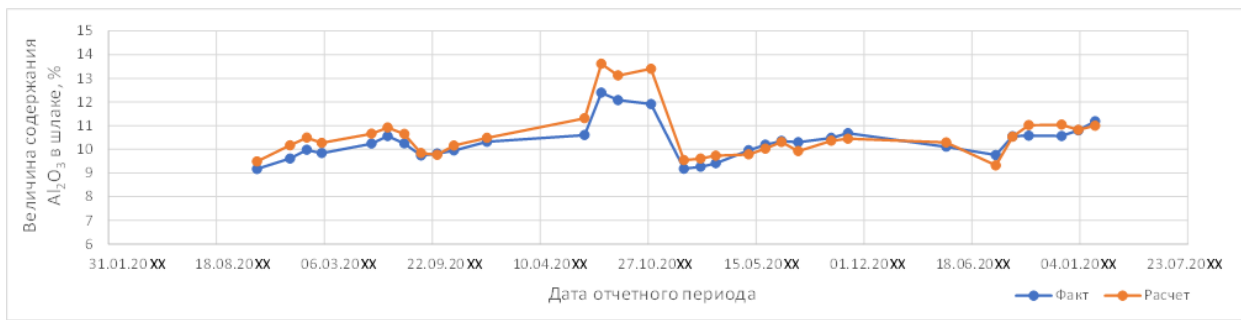
Рисунок 4 – Сопоставление во времени фактических и расчетных величин содержания Al_2O_3 в шлаке
