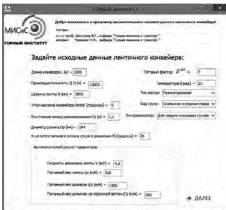
Рисунок 4 - Окно уточненного тягового расчета первого блока программного комплекса
