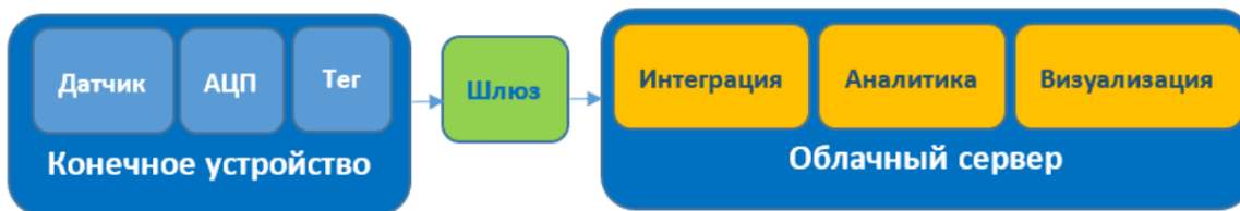
Рисунок 2 – Передача информации с конечного устройства в облако
