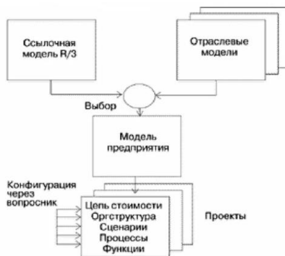
Рисунок 2 – Конфигурирование SAP/R3 с помощью инструментария Business-Engineer
