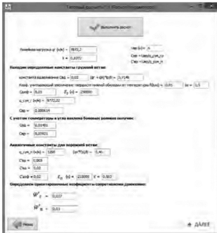
Рисунок 3 - Основное окно программы тягового расчета ленточного конвейера
