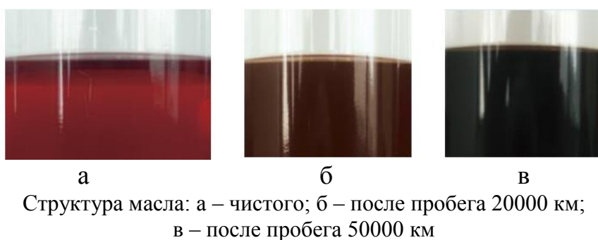
Рисунок 1 – Схема, иллюстрирующая степень загрязнения моторного масла
