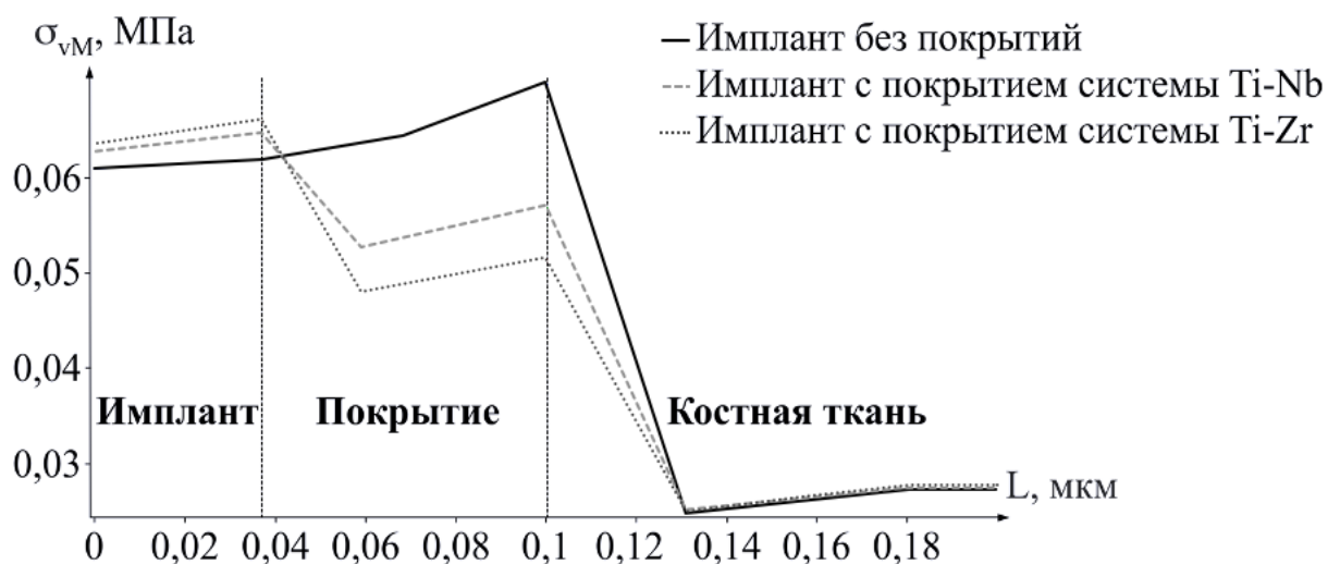
Рисунок 3 – распределение напряжений по Мизесу на границе между зубным имплантатом и костной тканью
