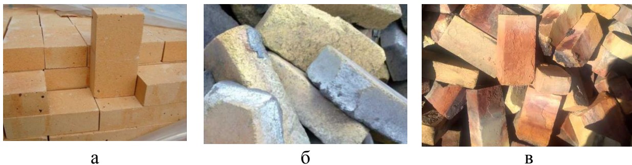
а – стандартные изделия; б – лом отработанных огнеупоров плавильной печи; в – лом отработанных огнеупоров нагревательной печи
