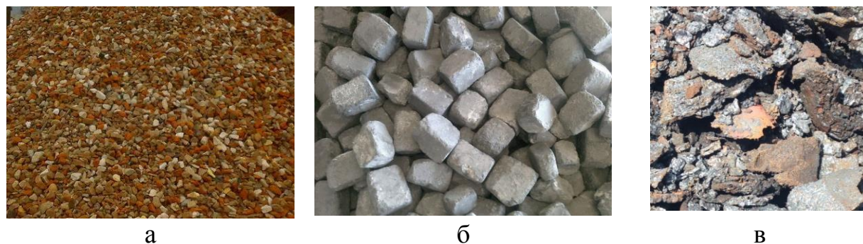
а – огнеупорный щебень; б – отсортированные изделия; в – металлические включения, извлеченные магнитной сепарацией
