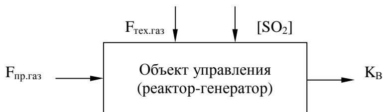
Рисунок 1 – Структурная схема объекта управления (реактор-генератор): F_{\text{пр.газ}} – расход природного газа на восстановление; F_{\text{тех.газ}} – расход технологического газа; [SO_2] – концентрация серы в исходном технологическом газе; K_{\text{в}} – коэффициент восстановления.
