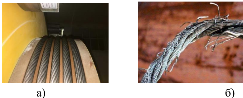
Рисунок 1 – а) расположение подъёмных канатов на канатоведущем шкиве; б) изношенный канат
