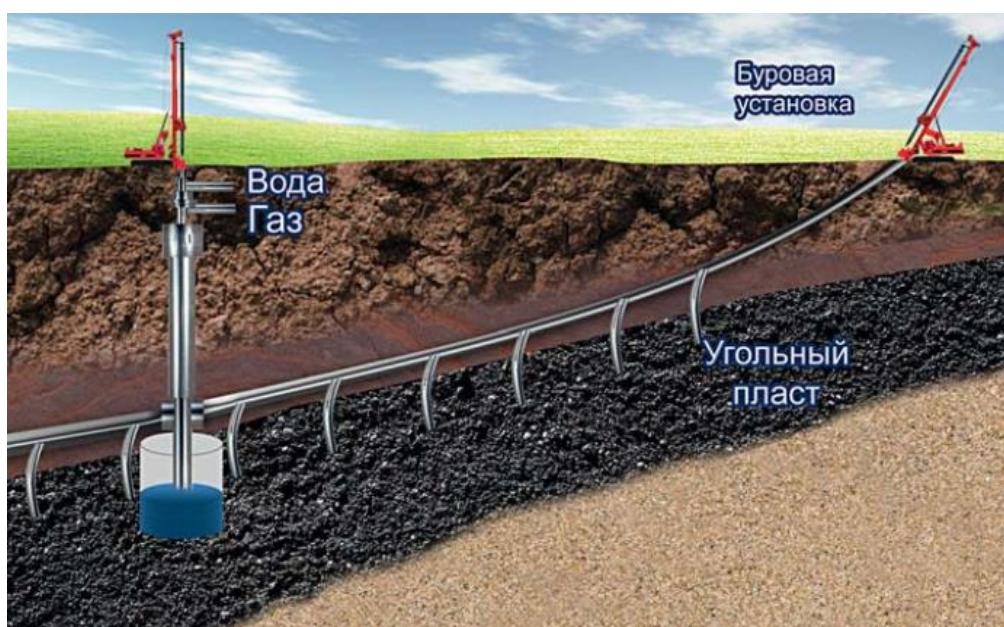
Рисунок 2 – Заблаговременная дегазация с использованием многофункциональной наклонной буровой установки [1]
