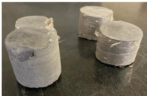
Рисунок 1 – Образцы пород непосредственной кровли пласта 7-7а цилиндрической формы
