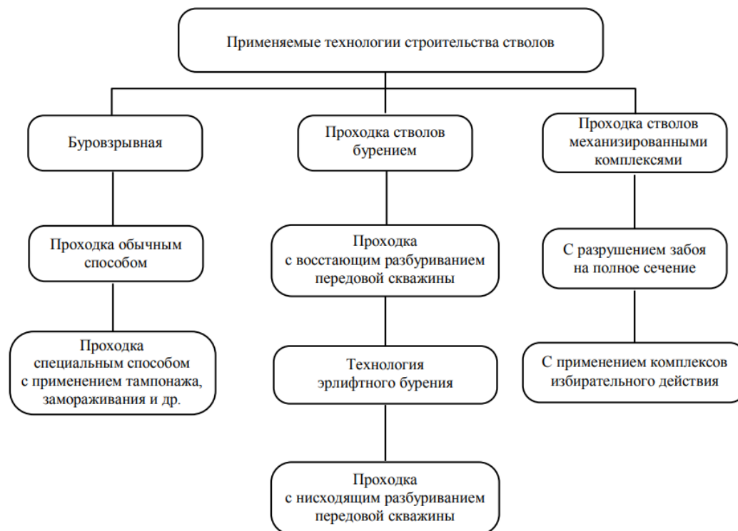
Рисунок 1 – Технологии строительства вертикальных стволов [1]
