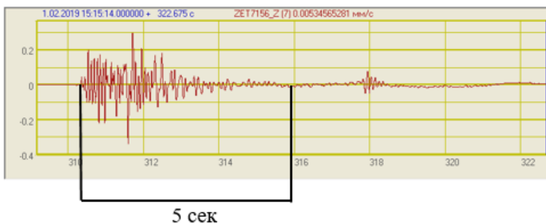
Рисунок 2 – Сейсмограмма массового взрыва с замедлением 42 мс в магистральной сети
