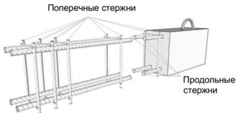
Рисунок 4 – Схема армирования железобетонной балки
