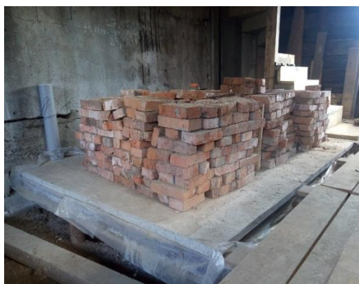
Рисунок 6 – Приложение эквивалентной равномерно распределённой нагрузки к монолитной плите
