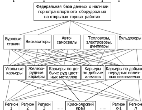
Рис. 1. Схема информационных потоков в мониторинге данных о горнотранспортном оборудовании, задействованном на открытых горных работах на территории РФ
