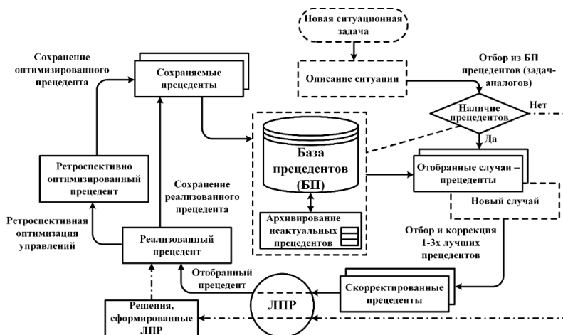
Рис. 1. Предлагаемый CBR-цикл выработки и реализации управляющих решений в системе управления сложным производственным комплексом на основе прецедентов
