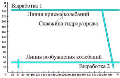
Рис. 1. Принципиальная схема сейсмического просвечивания между горными выработками
