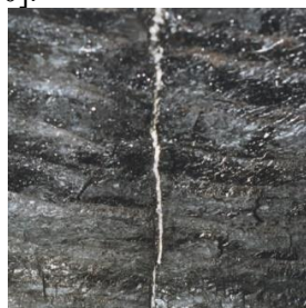
Рис. 1. Фотография гидроразрыва, секущего горизонтально залегающий угольный пласт (трещина расклинена кварцевым песком), шахта Dartbrook [9]
