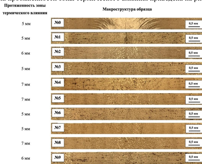
Рис. 1. Протяженность зоны термического влияния
