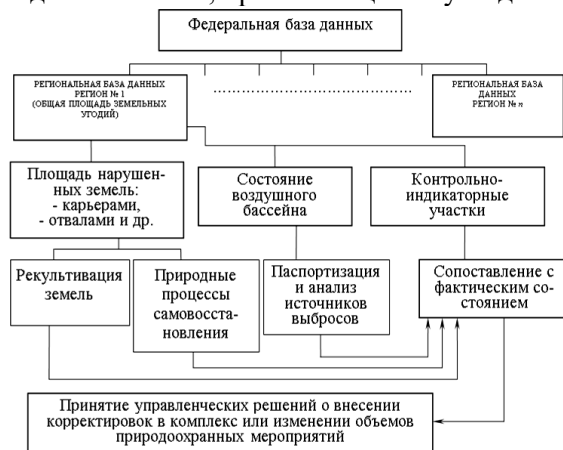
Рис. 1. Схема информационных потоков в трехуровневом мониторинге экологии угледобывающего производства с использованием информации дистанционного зондирования
