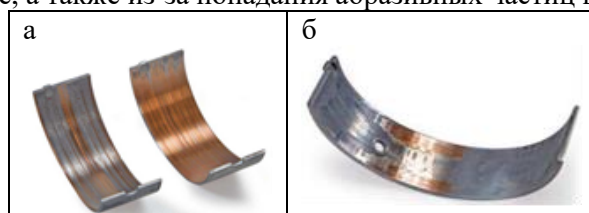
Рис. 1. Борозды износа (а) и неравномерный износ (б) рабочих поверхностей вкладышей ПЖТ
